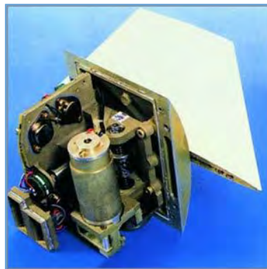
附图98：一种用于小型导弹尾翼的机电飞行控制执行机构。 (Daimler Benz Aerospace)
