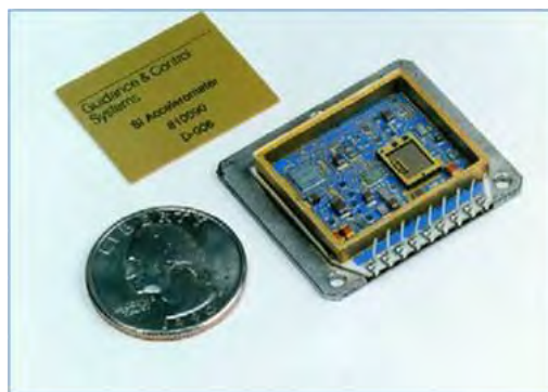
附图86：额定超过100g的集成电路加速度计。 《MTCR设备、软件和技术附件手册》第三版（2005年5月）
