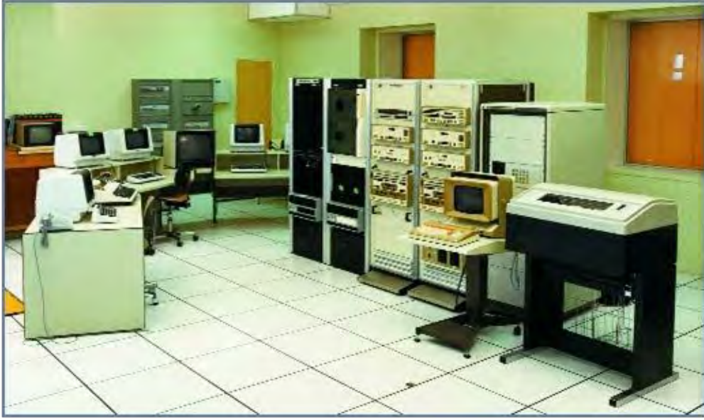
附图121：具有代表性的地面站遥测接收处理设备。（In-Snec）
