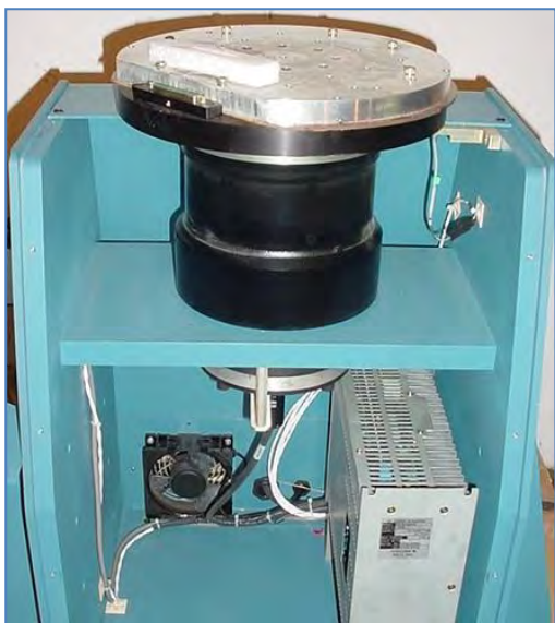
附图93：用于调谐陀螺的典型速率转台。 (Ideal Aeromsmith, Inc)
