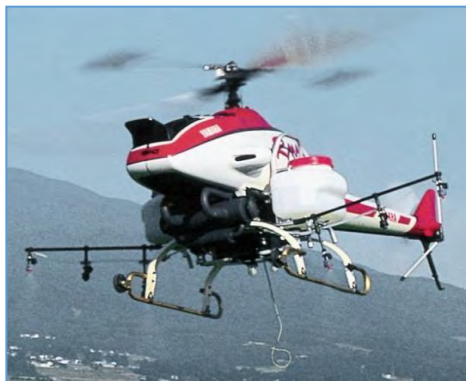
附图166：一种旋翼无人机，设有用于农业用途的化学储罐和喷嘴架。（Yamaha）
