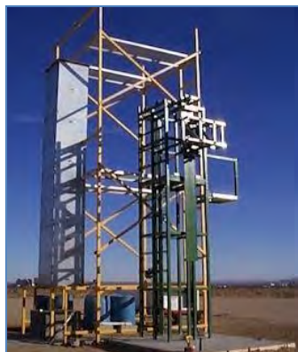
附图141：为测试液体火箭发动机而设计的立式试验台。（Interorbital Systems）
