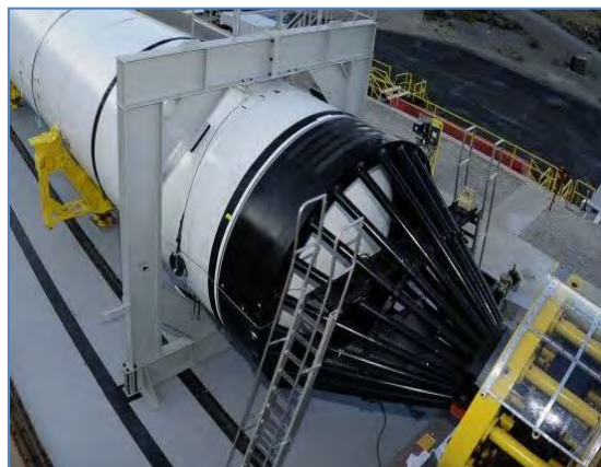
附图139：固体火箭发动机试验台负载测量系统。（ATK）
