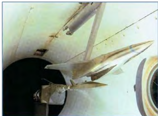
附图138: 位于高超声速风洞试验段的试验对象。 (《MTCR设备、软件和技术附件手册》第三版 (2005年5月))
