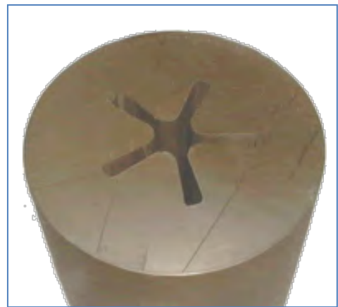
附图56：双基火箭发动机推进剂的样品。 （Bayern-Chemie GmbH）
