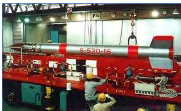
附图162：一种大型类别II探空火箭，能将250公斤有效载荷送到400公里的射程范围。火箭的固体推进剂发动机（带钢外壳），已安装好四个蜂窝状尾翼和钛合金前缘。（JAXA）
