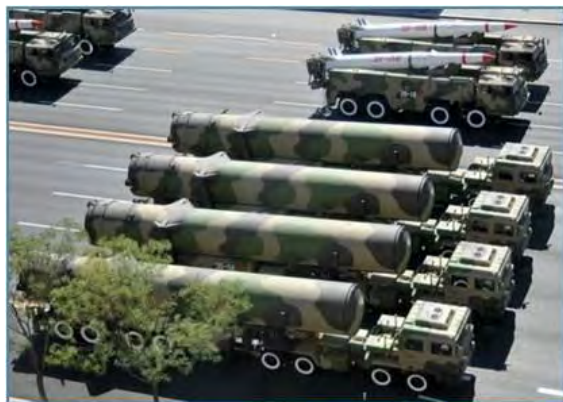
附图111：上图：运载洲际弹道导弹（ICBM；前景）的八轴TEL与运载中程弹道导弹（IRBM）的四轴TEL。（通过中国互联网）
