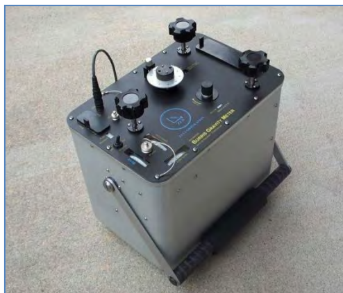
附图115：这种自动重力仪是最精确、最坚固和最轻便的重力仪之一。在正常情况下，mGal读数可在30秒内调平，漂移率小于0.5 mGals/每月。（ZLS公司）
