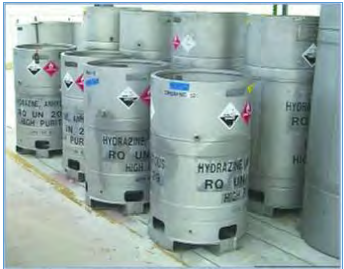
附图57：34加仑无水肼容器，采用300系列不锈钢制成。
