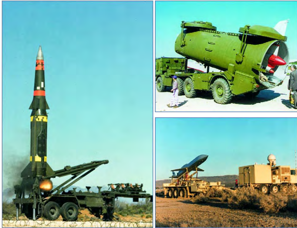
附图113：左侧：安装发射器与原动机分离。（《MTCR设备、软件和技术附件手册》第三版（2005年5月））右上：一种大型II类巡航导弹的运输装置安装发射器。（《MTCR设备、软件和技术附件手册》第三版（2005年5月））右下角：火箭辅助无人机的安装发射器及其相关的指挥和控制车。（特莱丁瑞安航空公司）
