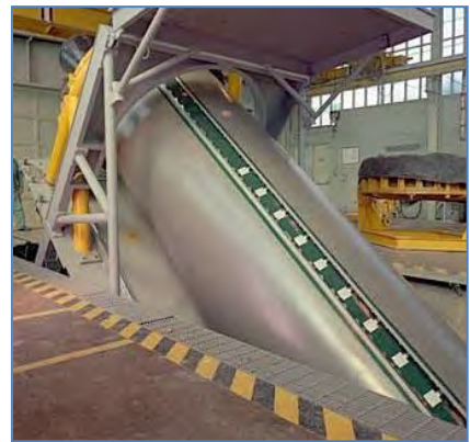
附图49：将液体形式的固体推进剂倒入火箭壳体中，并浇铸成所需的形状。铸件采用液压支架移动，以消除气泡或其他缺陷。（ATK）
