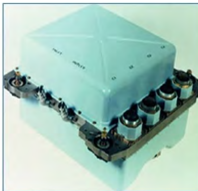
附图129：带液冷的防辐射电子组件。(The Charles Stark Draper Laboratory, Inc.)
