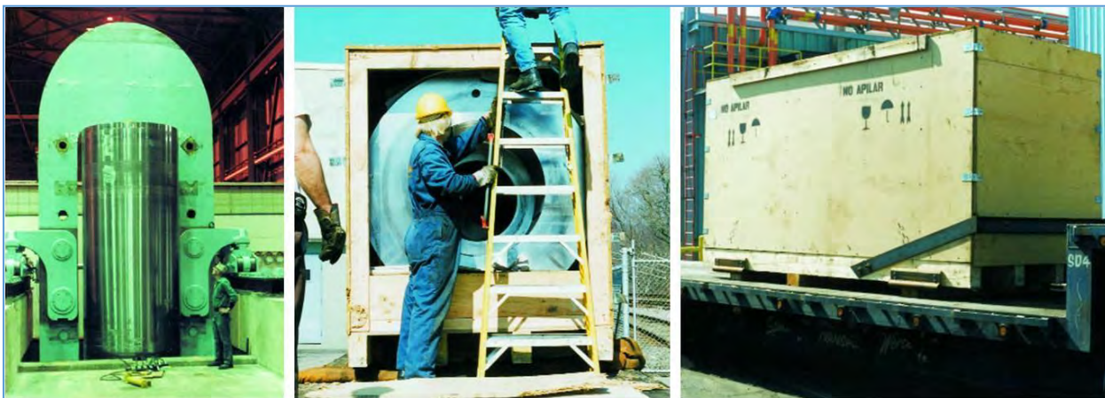
附图66：左侧：大型等静压机的侧面图。（Engineered Pressure Systems, Inc.）中间和右侧：一种用于等静压机的替代运输板条箱的两种视图。（Engineered Pressure Systems, Inc.）
