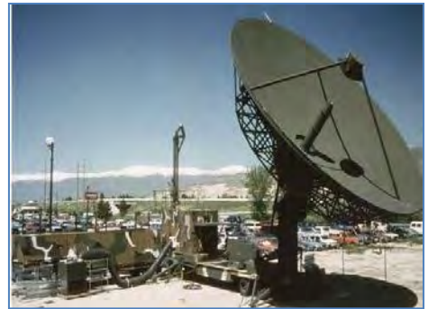
附图119：大型卫星通信军用天线，设计用于大型指挥所和移动指挥所，适合与无人机通信。（通用动力公司）
