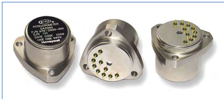
附图77：此加速度计可用于许多商业和军事捷联惯性导航系统。（Honeywell）
