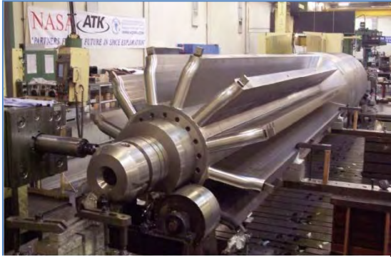
附图48：推进剂浇注心轴（ATK）
