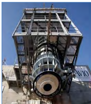
附图140：试验台上的固体推进剂火箭发动机。（Avio SpA）
