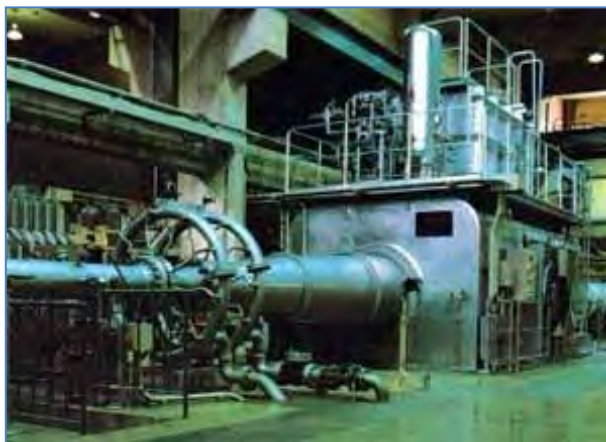
附图136: 高超音速风洞，其速度可达5马赫，用于测试运载火箭的飞行条件。（三菱重工）
