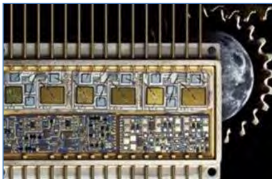
附图159：一种用于强辐射军事和航天应用的辐射硬化发动机驱动器。（Aeroflex）
