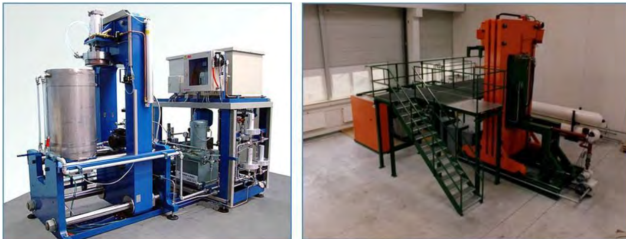
附图65：左侧：实验室用的等静压机。（ESPI）右侧：实验室用的热等静压机。（Abra Fluid AG）
