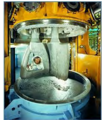
附图53：固体推进剂正在600加仑的垂直行星式搅拌机中搅拌混合。（Thiokol Corp.）
