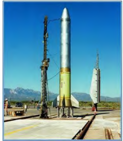
附图108：带龙门塔架最小的发射台，与一个完整的火箭系统相连。 （《MTCR设备、软件和技术附件手册》第三版（2005年5月））
