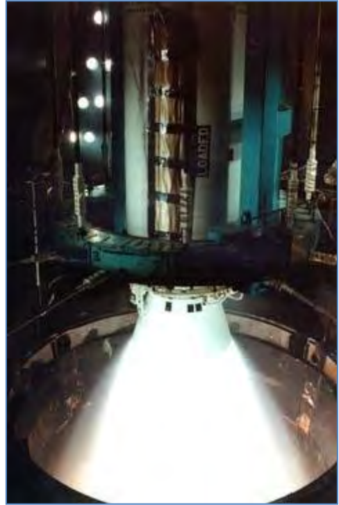
附图142：正在模拟高空测试的全尺寸固体火箭发动机。（AEDC）
