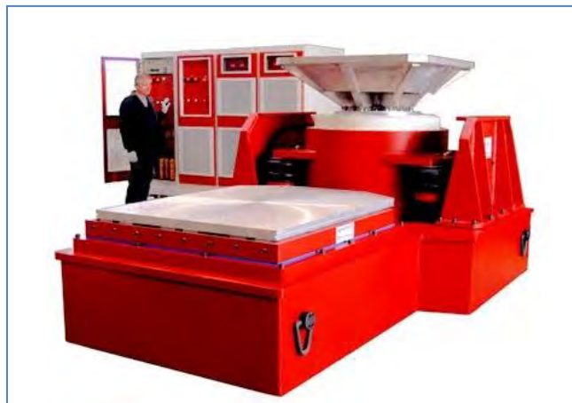
附图135：带滑台的推进器示例。（Kingdom Pty Ltd）
