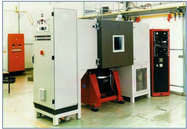
附图144: 具有振动试验能力的受控环境舱。 (RMS Dynamic Test Systems)
