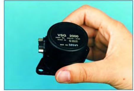
附图81：振动结构陀螺仪。（British Aerospace Ltd.）
