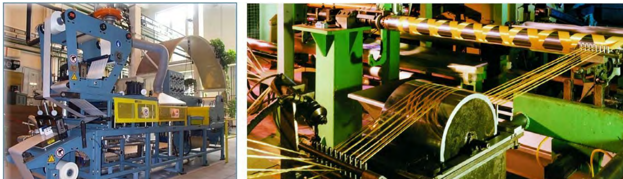
附图64：左侧：Composite Materials Group制造的预浸机,用于纤维和树脂预浸料的生产。（Katholieke Universiteit Leuven）右侧：向7条粗纱线添加树脂的机器。（Hunting Engineering, Ltd.）
