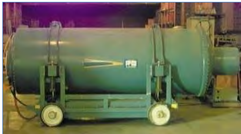
附图146: 用于检查固体火箭发动机的2.3MeV闪光x射线装置。 (《MTCR设备、软件和技术附件手册》第三版(2005年5月))
