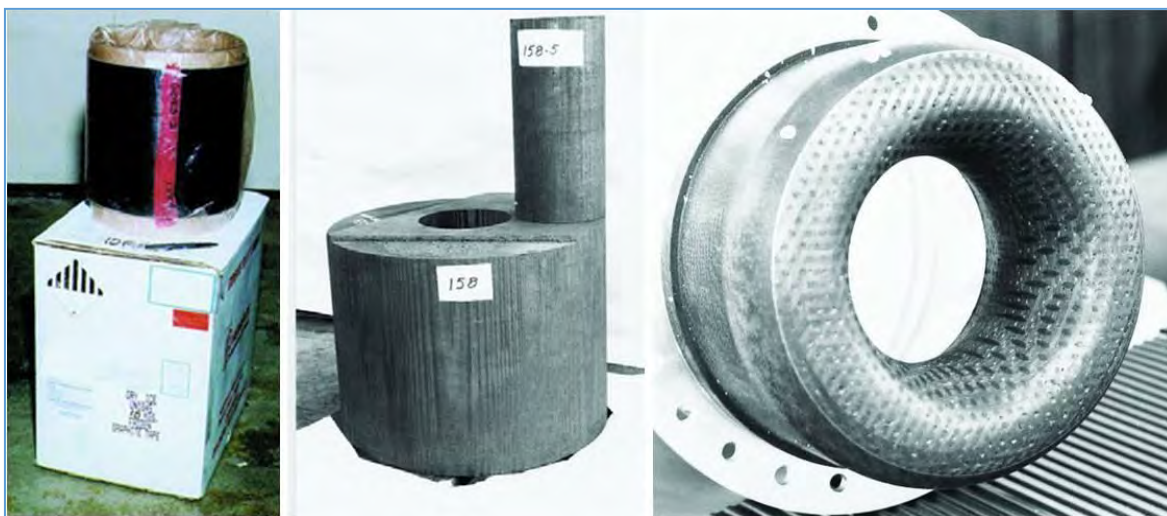
附图69 左侧：特殊的硬纸板容器，用于在运输过程中将干冰包裹在碳纤维预浸带轴周围。干冰通常装在一个塑料袋里，并且，塑料袋则包裹在线轴周围。（《核供应国集团双重用途手册附件》，报告编号LA-13131-M（1996年4月））中间：一块准备加工成火箭喷嘴的碳-碳材料。较大的圆柱体直径约为70厘米。（Ibid）右侧：一个碳-碳火箭喷嘴喉部，可看到底层纤维的织物图案。（Ibid）
