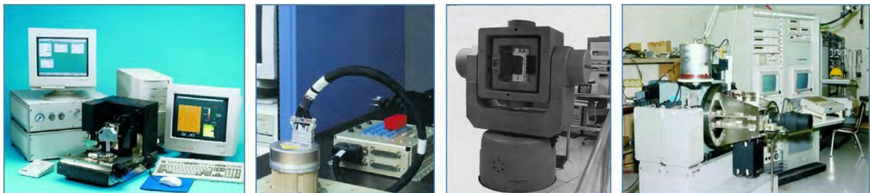
附图95：左侧：用于测量镜像的轮廓仪系统。（Digital Instruments）中左：是另一个连接到微型IMU的便携式IMU测试仪。（Litton Guidance and Control Systems）中右：是一个三轴台，用于测试IMUs或陀螺仪。
