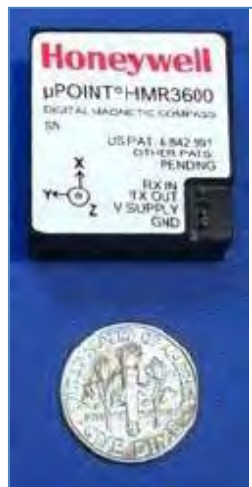
附图92：此陀螺稳定磁指南针模块使用三轴磁航向传感器。（Honeywell）
