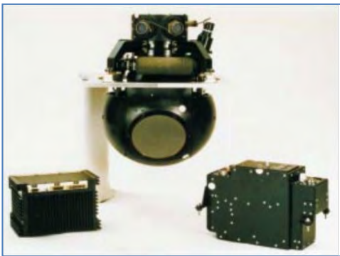
附图99：一种用于无人机（顶部）及其相关电子设备的红外成像传感器。（LFK-GmbH）
