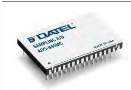
附图130：一种模数转换器，主要用于雷达信号分析。（Datal）
