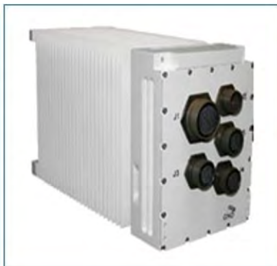
附图128：另一种多平台任务计算机，专门设计用于使用条件苛刻的航空航天和军事领域。(Curtiss Wright 嵌入式计算控制)
