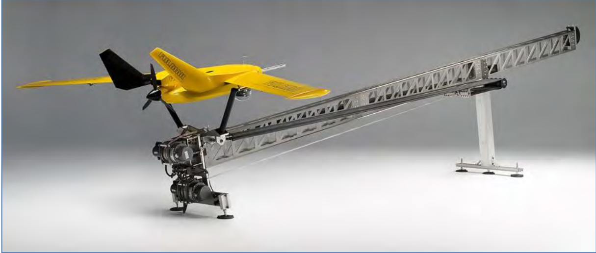
附图164：一架中等续航能力无人机。尽管体积小，这种弹性弹射无人机能够携带1公斤有效载荷（红外和数码相机），且航程可达400公里。（Aerovision Vehiculos Aereos, SL）
