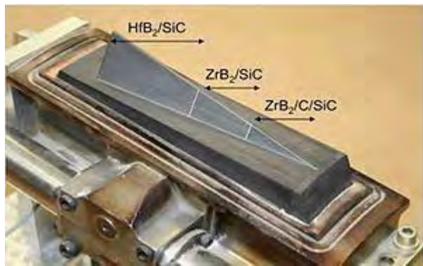
附图73：由三个不同部分组成的UHTC船体列板，且具有不同的UHTC组分（《陶瓷复合材料手册》）
