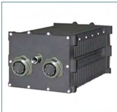
附图127：多平台任务计算机。其紧凑的尺寸使其对于部分无人机上封闭的空间来说非常理想。 (Curtiss Wright Embedded Computing Controls)
