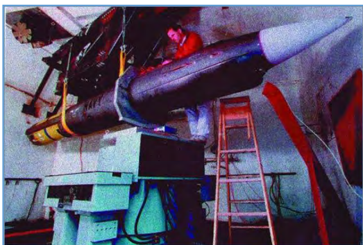
附图133：准备进行导弹振动测试的推进器。 (Unholtz-Dickie)
