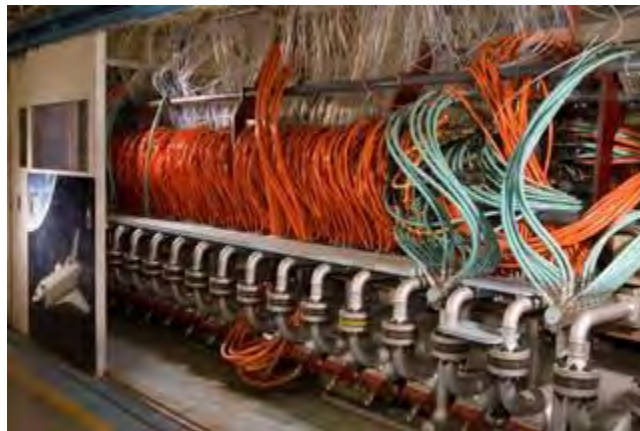
附图147：交互加热装置（60mw）电弧射流。（美国国家航空航天局（NASA））
