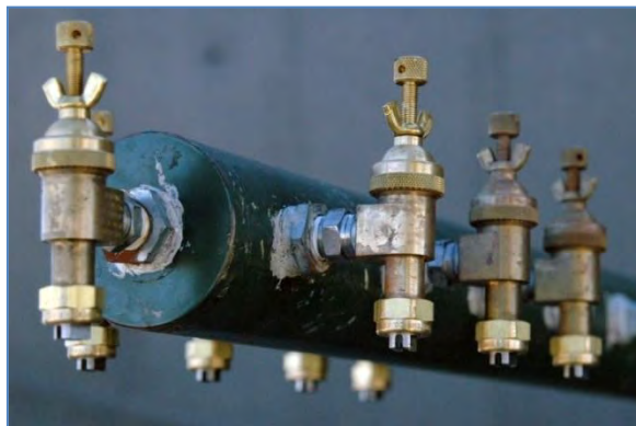
附图165：一个模块化的空中喷洒系统，用于杀虫剂的应用，可使用一个称为超小体积的专用喷雾臂喷嘴的设置（就像此处展示的这些喷嘴一样）在一英亩土地上喷洒半盎司至一盎司的化学物质。（美国空军）
