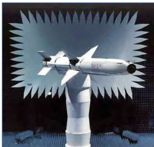
附图156: 位于Bistatic Anechoic Chamber (BAC) RCS测量紧缩场的目标导弹。 (美国海军)
