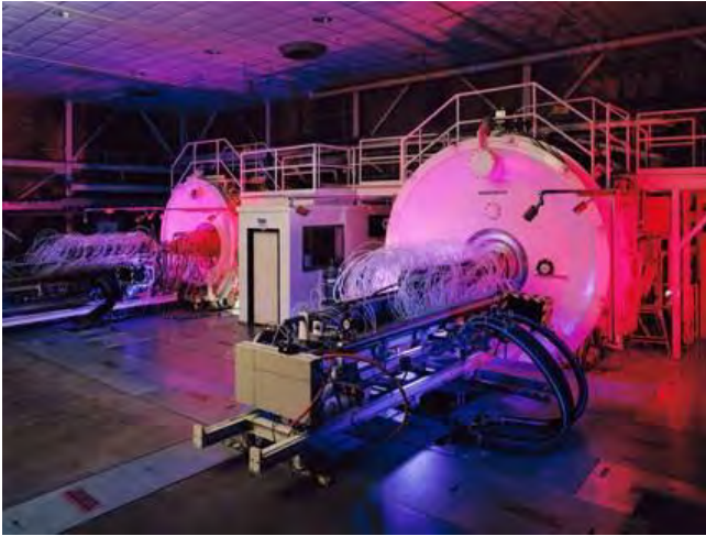
附图148：约翰逊航天中心（JSC）大气再入材料和结构评估设施（电弧喷射）（NASA）内部场景
