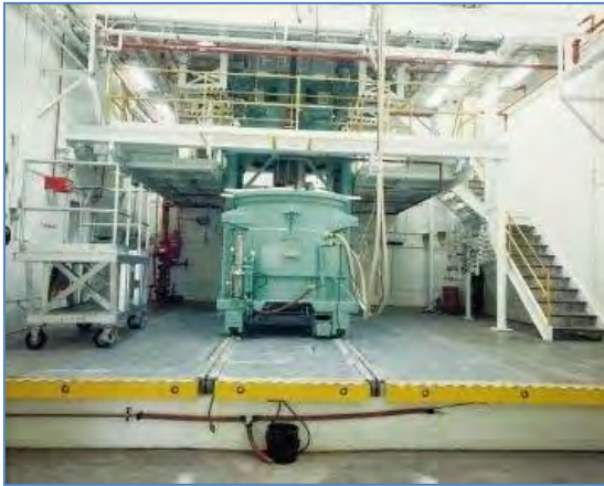
附图52：420加仑的推进剂搅拌容器。（ATK）
