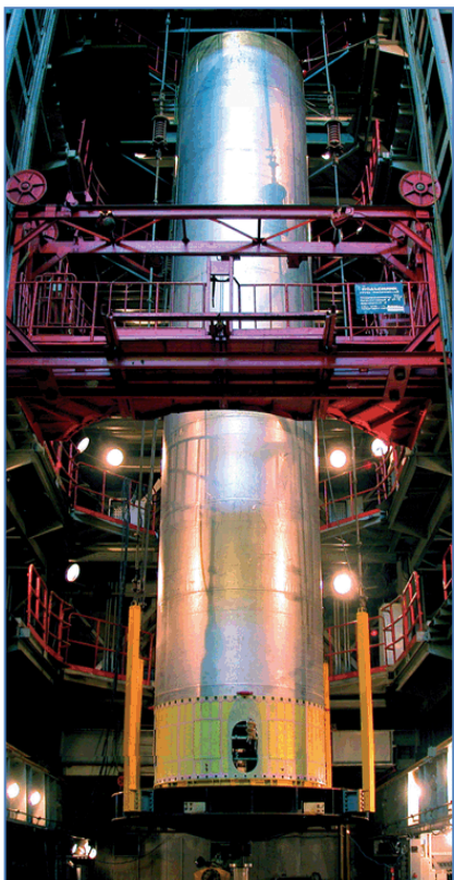
附图134：振动试验台的核心一级助推器。 (Krunichev航天中心)
