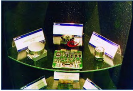
附图83：一个FOG陀螺仪（左），一个RLG陀螺仪（中），一个加速度计（右）。（《MTCR设备、软件和技术附件手册》第三版（2005年5月））
