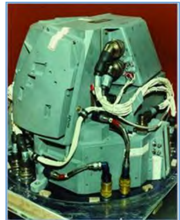
附图74：巡航导弹综合飞行仪表系统的主体。（Litton Guidance and Control Systems）
