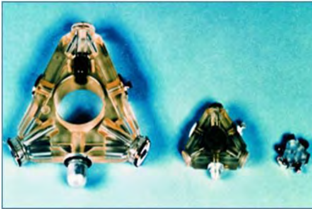
附图83：一个FOG陀螺仪（左），一个RLG陀螺仪（中），一个加速度计（右）。（《MTCR设备、软件和技术附件手册》第三版（2005年5月））
