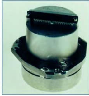
الشكل ٨٢: جيروسكوب مضبوط ديناميكياً (DTG). (ذا تشارليز سترك درابر لابوراتوريز انك)
