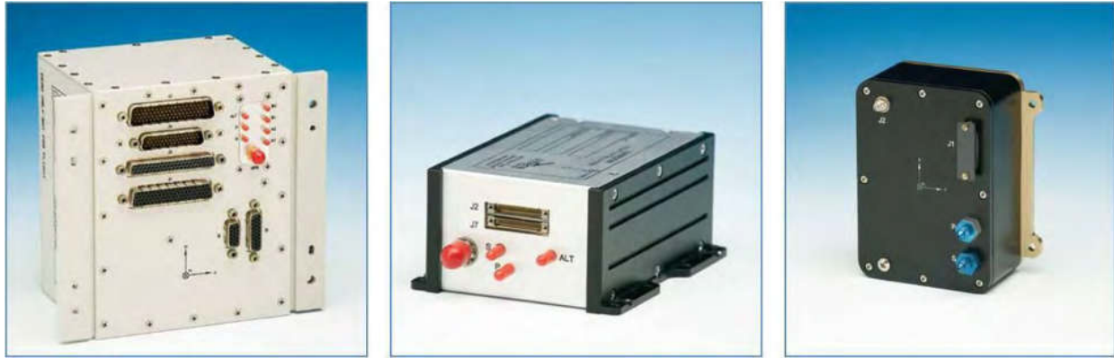
الشكل ٧٥: مجموعة مختارة من نظم الملاحة بالقصور الذاتي (INS) المصممة لتطبيقات المركبات الجوية غير المأهولة. من اليمين: أجهزة التحكم الآلي في الطيران ونظام إدارة المهمة في المركبات الجوية غير المأهولة؛ ونظام INS/GPS متكامل بشكل تام؛ يمتلك جهاز جيروسكوب حالة صلبة متكامل، وأجهزة قياس تسارع، ومقياس شدة المغناطيسية، ومستقبل GPS. (روكويل كولينز)
