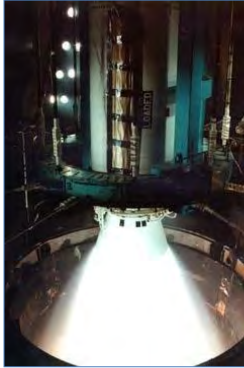
الشكل ١٤٢: محرك صاروخي بالوقود الصلب بنطاق كامل قيد الاختبار في ارتفاع محاكاة عالي. (إيه آي دي سي)
