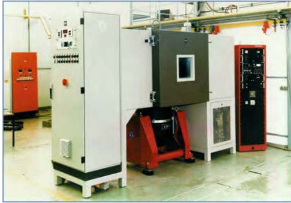
الشكل ١٤٤: حجرة بيئية خاضعة للمراقبة مزودة بقدرة اهتزاز. (آر إم إس ديناميك تيس تسيستمز)
