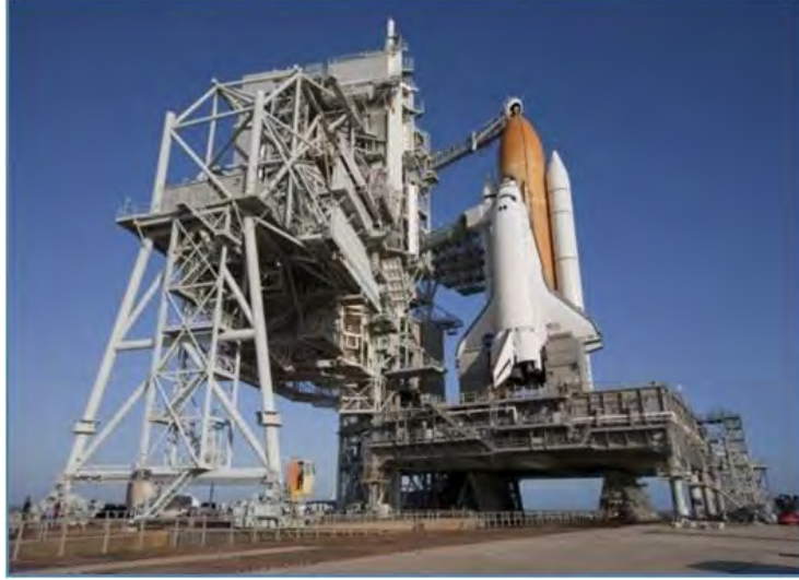
الشكل ١٠٩: منصة إطلاق خاصة بمكوك فضائي على منصة إطلاق متحركة قبل الإطلاق (ناسا).
