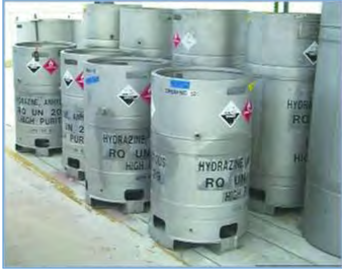
الشكل ٥٧: حاوية شحن هيدرازين لا مائي سعة ٣٤ غالون مصنوعة من الفولاذ الذي لا يصدأ من الفئة ٣٠٠. (دليل معدات وبرمجيات وتكنولوجيا نظام مراقبة تكنولوجيا القذائف، الإصدار الثالث (مايو ٢٠٠٥))
