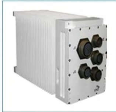
الشكل ١٢٨: حاسوب مهمة آخر لمنصات متعددة، هذا الحاسوب مصمم لاستخدامه في تطبيقات فضائية وعسكرية قاسية. (كورنيس رايت امبيدج كومبيوترج كونترولز)
