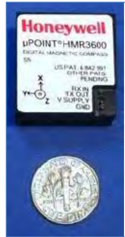
الشكل ٩٢: وحدة بوصلة جيروسكوبية مغناطيسية ثابتة تتضمن مستشعرات الاتجاه المغناطيسي ذات المحاور الثلاثة. (هوني ويل)
