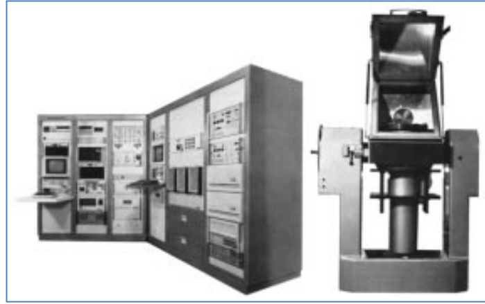
الشكل ٩٤: منضدة ضبط ذات محورين تتضمن محطة اختبار جيروسكوبية تستفيد من محاكي الحركة/منضدة الضبط. (كونترافس تك)
