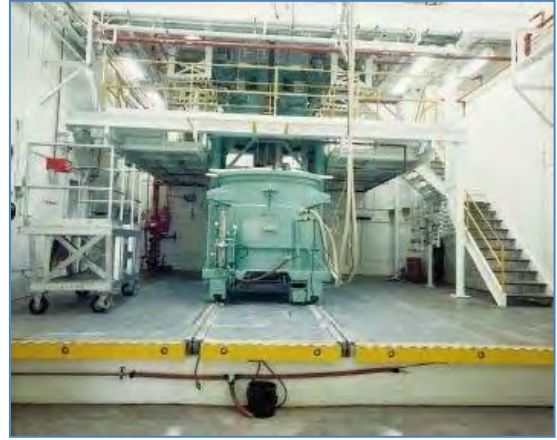
الشكل (٥٢): وعاء خلط ووقود دفعي كوكبي سعة ٤٢٠ غالون. (أيه تي كيه)
