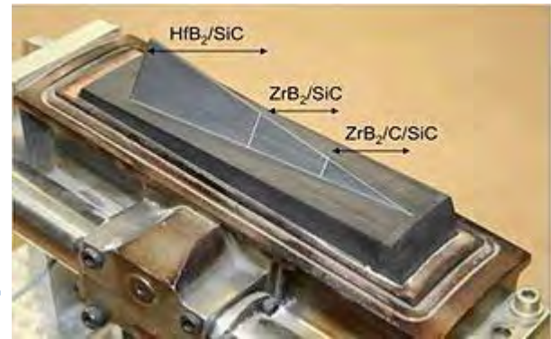
الشكل ٧٣: لوح طولي من الخزف المشكل بالحرارة الفائقة يتضمن ثلاثة أقسام مختلفة من ثلاثة مركبات من الخزف المشكل بالحرارة الفائقة (دليل مركبات الخزف)
