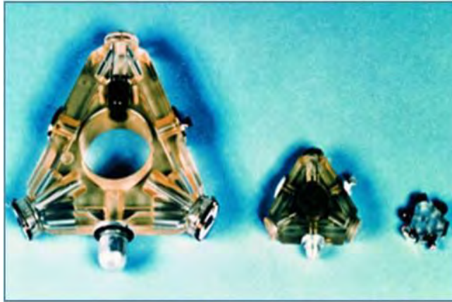
الشكل ٨٣: جيروسكوب ألياف بصرية (FOG) على اليسار، جيروسكوب الليزر الحلقي (في الوسط)، ومقياس تسارع (على اليمين). (دليل معدات وبرمجيات وتكنولوجيا نظام مراقبة تكنولوجيا القذائف، الإصدار الثالث (مايو ٢٠٠٥))
