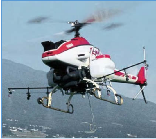
الشكل ١٦٦: مركبة جوية غير مأهولة ذات جناح دوار تتضمن خزانات مواد كيميائية وقضبان رش للأغراض الزراعية. (ياماها)
