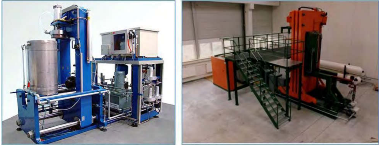
الشكل ٦٥: على اليسار: مكبس ضغط مخصص للمختبرات (اي اس بي آي). على اليمين: مكبس ضغط ساخن مخصص للمختبرات (أبرا فلويد ايه جي)
