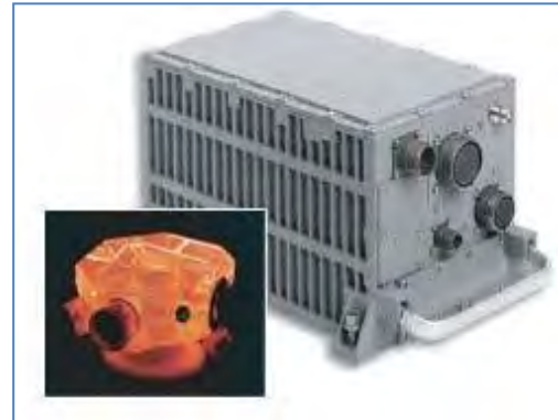
الشكل ٨٩: وحدة قياس بالقصور الذاتي ونظام تحديد المواقع العالمي مع جيروسكوب ليزري (داخلي). (نورثروب غرومان).
