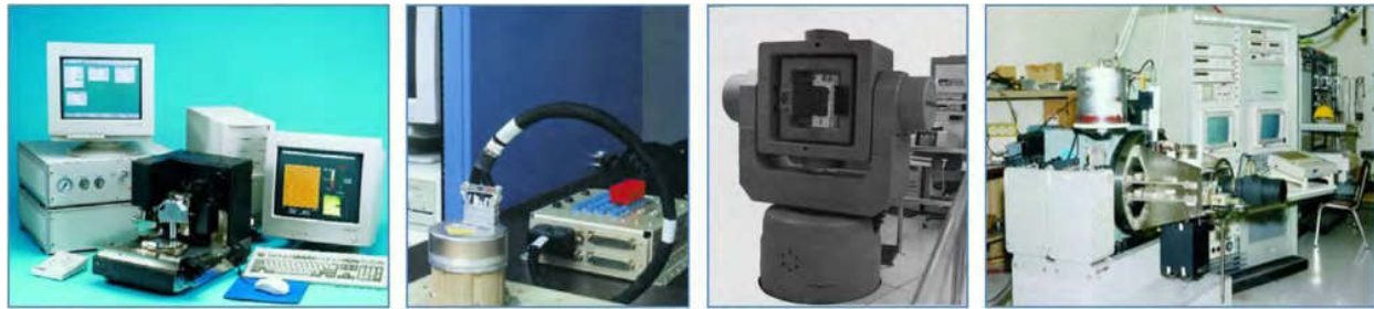
الشكل ٩٥: على اليسار: مقياس تباين الأسطح يستخدم لقياس المرايا. (ديجيتال استرنمنتس). وسط اليسار: فاحص وحدة القياس بالقصور الذاتي آخر محمول متصل مع وحدة قياس بالقصور الذاتي مصغرة. (ليتون جايدالس أند كونترول سيستمز). وسط اليمين: طاولة ثلاثية المحاور لقياس وحدة القياس بالقصور الذاتي أو الجيروسكوب.
