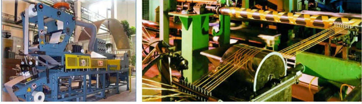
الشكل ٦٤: على اليسار: آلة إنتاج مواد تقوية تحضيرية مبنية من قبل مجموعة كومبوزيت ماتيريال غروب لإنتاج مواد التقوية التحضيرية باستخدام الألياف والرائنج. (كاتوليك يونيفرسيتي ليوفين). على اليمين: آلة تضيف الرائنج على سبعة خطوط حزم ألياف مستمرة. (هالننج تجينيرنج ليمتد)
