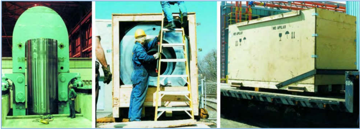
الشكل ٦٦: على اليسار: صورة جانبية لمكبس ضغط متساوي (الجنيرينج بريشر سيستمز انك). على اليمين: زاويتان مختلفتان لصندوق شحن بديل للمكبس متساوي الضغط (الجنيرينج بريشر سيستمز انك).
