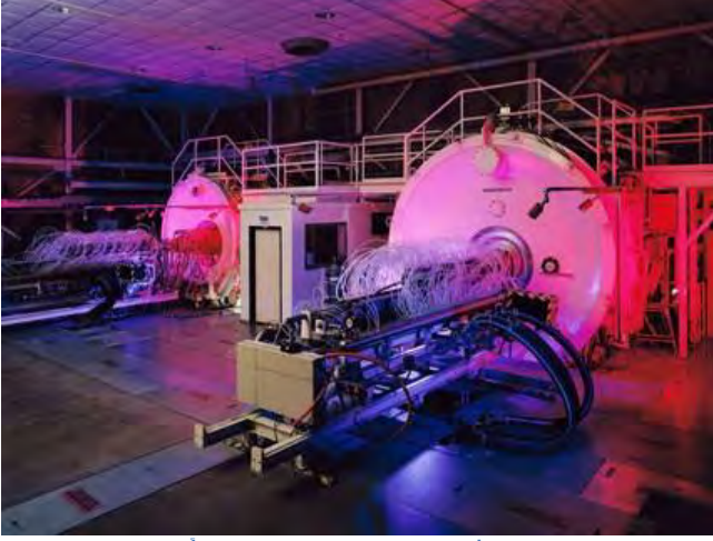
الشكل ١٤٨: صورة داخلية لمركز جونسون الفضائي. منشأة تقييم مواد الغلاف الجوي العائدة والهياكل (قوس النفث). (ناسا)
