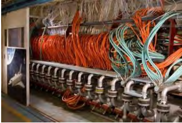
الشكل ١٤٧: منشأة تسخين تقاعلي (٦٠ ميغا وات). (ناسا)
