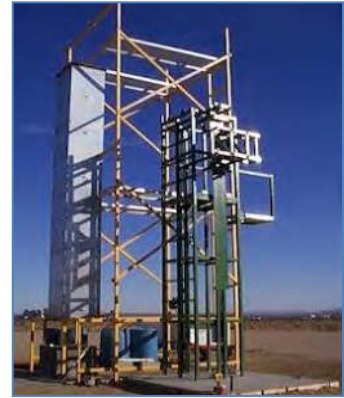
الشكل ١٤١: منصة اختبار عامودية مصممة لاختبار محركات الصواريخ بالوقود السائل. (انترأوربتال سيستمز)
