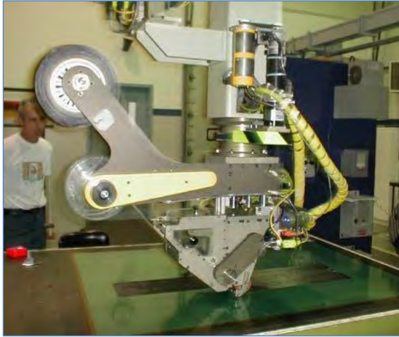
الشكل ٦٢: رأس آلة لف شرائط ألي (أوتوماتيد ديناميكس)
