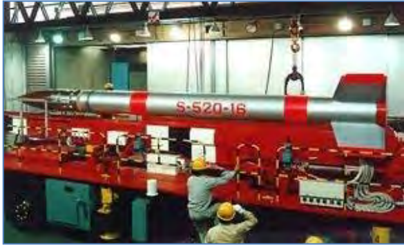
الشكل ١٦٢: صاروخ مسباري ضخّم من الفئة ٢ قادر على إيصال حمولة تبلغ ٢٥٠ كغ إلى مدى يبلغ ٤٠٠ كم. المحرك الصاروخي العُمل بالوقود الصلب ذو الغلاف المعدني محاط بأربعة زعانف ذيل على شكل قرص العسل مع حافة أمامية من سبائك التيتانيوم. (جاكسا)
