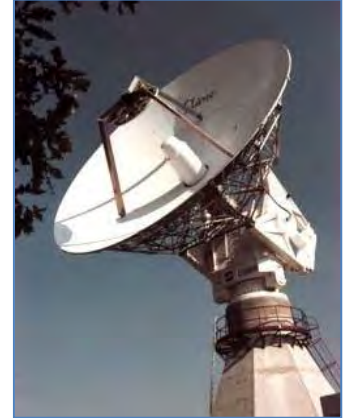
الشكل ١١٨: نظام هوائي قياس عن بعد ضخم مصمم للمركبات الجوية غير المأهولة ومراكز اختبار الطيران. (تشيلتون أنتيناز)
