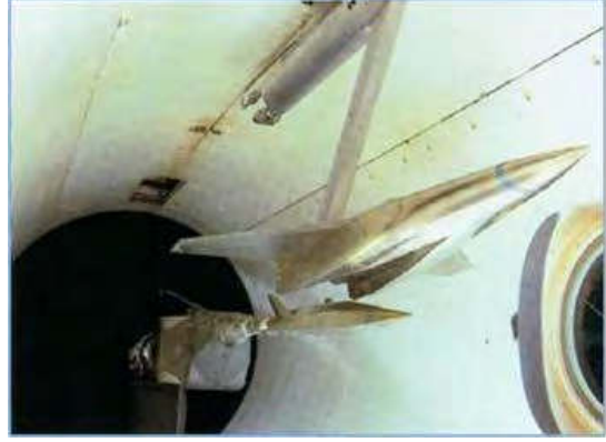
الشكل ١٣٨: جسم خاضع للاختبار في قسم الاختبار الخاص في نفق ريحي سرعته أسرع من الصوت. (دليل معدات وبرمجيات وتكنولوجيا نظام مراقبة تكنولوجيا القذائف، الإصدار الثالث (مايو ٢٠١٥))
