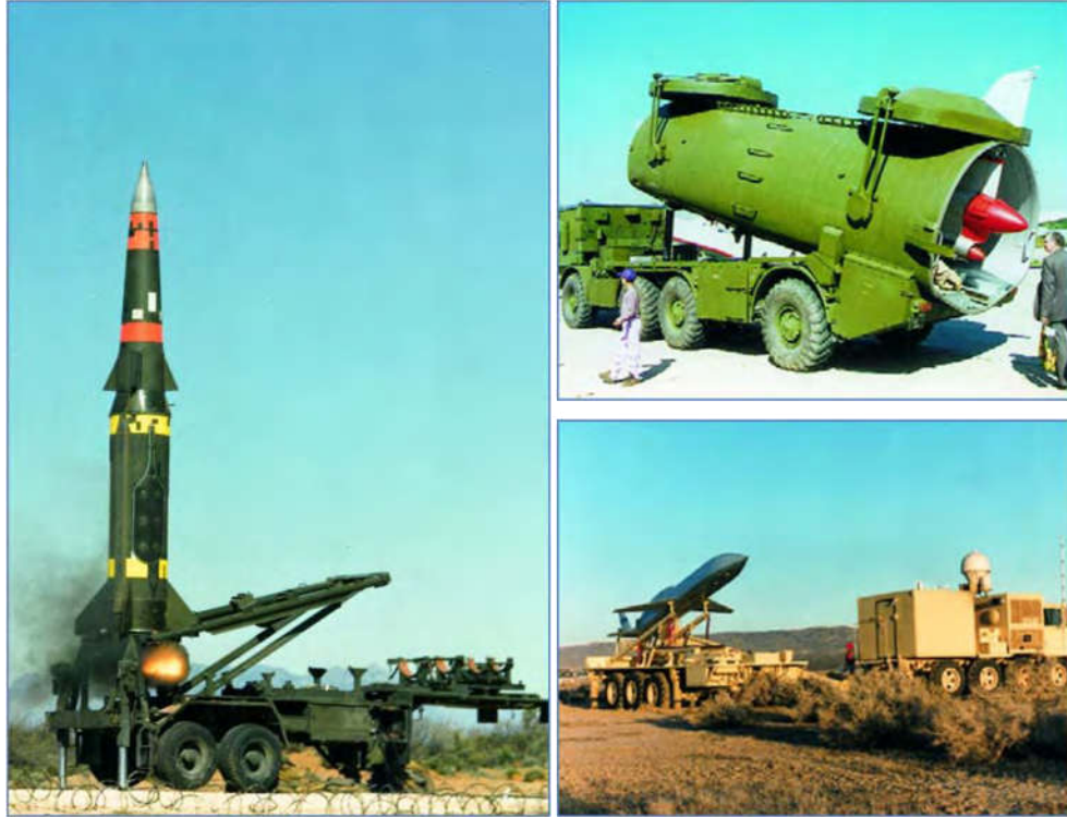
الشكل ١١٣: على اليسار: مركبة ناصبة قاذفة مفصولة عن ناقلتها الرئيسي. (دليل معدات وبرمجيات وتكنولوجيا نظام مراقبة تكنولوجيا القذائف، الإصدار الثالث (مايو ٢٠٠٥)). أعلى اليمين: مركبة ناصبة قاذفة ناقلة مخصصة للقذائف النسيابية الضخمة من الفئة ٢. (دليل معدات وبرمجيات وتكنولوجيا نظام مراقبة تكنولوجيا القذائف، الإصدار الثالث (مايو ٢٠٠٥)). أسفل اليمين: ناصبة قاذفة للمركبات الجوية غير المأهولة المدعمة بصاروخ ونظام الأوامر والتحكم المرافق لها. (تيليدين ريان أيرنوتيكال).
