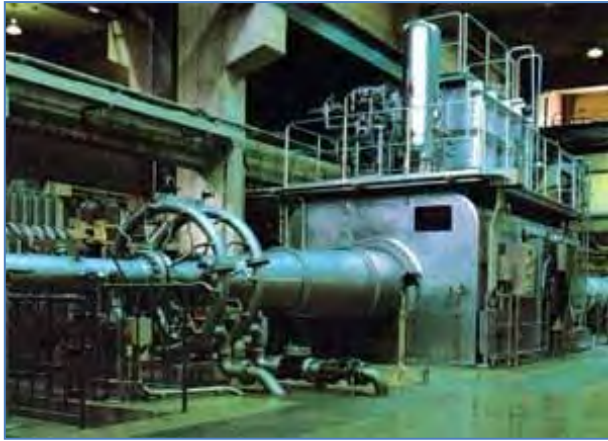
الشكل ١٣٦: نفق ريحي بسرعة أسرع من الصوت بدرجة تعادل ٥ ماخ للاختبار ظروف طيران مركبات الإطلاق. (ميتسوبيشي للصناعات الثقيلة)
