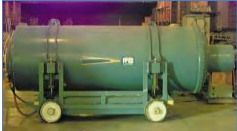
الشكل ١٤٦: وحدة أشعة سينية ومضية بقوة ٢,٣ ميغا فولت لمعاينة المحركات الصاروخية بالوقود الصلب. (دليل معدات وبرمجيات وتكنولوجيا نظام مراقبة تكنولوجيا القذائف، الإصدار الثالث (مايو ٢٠٠٥))
