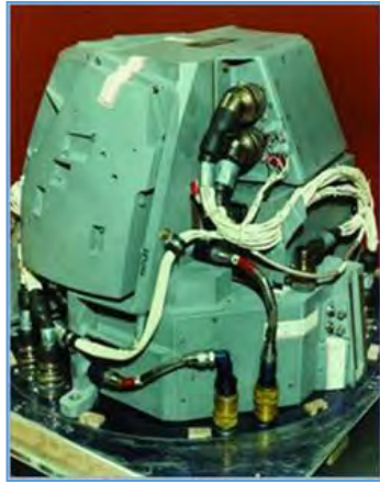
الشكل ٧٤: نظم أدوات الطيران المتكاملة الملحقة بالهيكل الرئيسي لقذيفة تسيابية. (ليتون للنظم التوجيه والتحكم).
