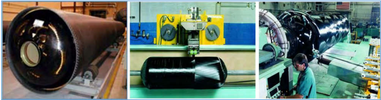
الشكل ٦١: على اليسار: غلاف غرافيت مطلي بالبابوكسي تم إنتاجه بواسطة آلة لف فتائل متطورة. (أيه تي كيه) في الوسط: آلة لف فتائل مثبتة على سطح منضدة. (ثيوكول كورب). على اليمين: آلة لف فتائل مع بكرات ألياف متعددة (أبييد)
