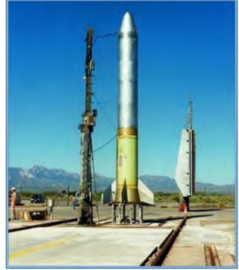
الشكل ١٠٨: منصة إطلاق بالحد الأدنى مع هيكل مؤقت وتوصيلات مع نظام صاروخي كامل. (نيليل معدات وبرمجيات وتكنولوجيا نظام مراقبة تكنولوجيا القذائف، الإصدار الثالث (مايو ٢٠٠٥))
