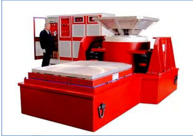
الشكل ١٣٥: مثال على مضخم اهتزاز مع منضدة منزلقة. (كنجندوم بي تي واي ليمتد)
