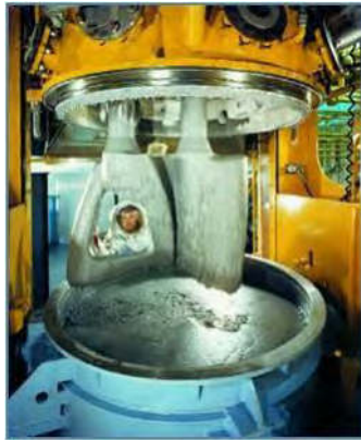
الشكل ٥٣: وقود دفعي صلب يتم خلطه في خلط كوكبي أفقي سعة ٦٠٠ غالون. (نيوكول كورب)
