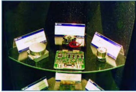
الشكل ٨٣: جيروسكوب ألياف بصرية (FOG) على اليسار، جيروسكوب الليزر الحلقي (في الوسط)، ومقياس تسارع (على اليمين). (دليل معدات وبرمجيات وتكنولوجيا نظام مراقبة تكنولوجيا القذائف، الإصدار الثالث (مايو ٢٠٠٥))
