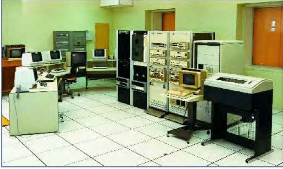
الشكل ١٢١: صورة تمثيلية لمعدات استقبال ومعالجة القياس عن بعد في المحطة الأرضية (إن-ستريك)
