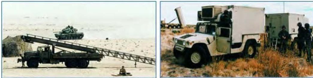
الشكل ١١٤: قاذفة مركبة جوية غير مأهولة هوائية. على اليمين: مركبات نظام الأوامر والتحكم ملائمة لإطلاق القذائف من مواقع ثابتة أو متحركة. (دليل معدات وبرمجيات وتكنولوجيا نظام مراقبة تكنولوجيا القذائف، الإصدار الثالث (مايو ٢٠٠٥)).
