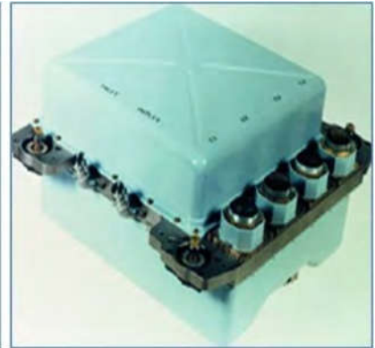
الشكل ١٢٩: منظومة أجهزة إلكترونية مصددة ضد الأشعة مع تبريد بالاسنان. (ذات تشارلز ستارك درابر لابوراتوي إنك)
