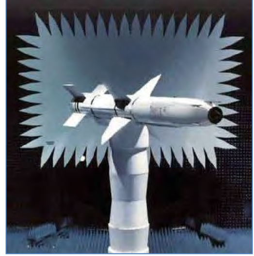
الشكل ١٥٦: قذيفة استهداف في وجحات امتصاص الموجات الراديوية، لقياس المدى المضغوط للمقطع العرضي للرادار. (البحرية الأمريكية)
