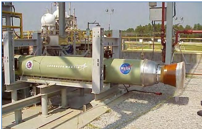
Schéma 19: Un moteur fusée à sonde hybride
