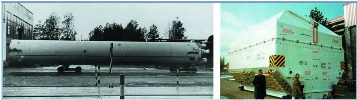
*Schéma 13 à Gauche: Premier étage d'un ICBM à carburant liquide. Droite: Un conteneur d'expédition pour un étage supérieur à carburant liquide. (Équipement de MTCR, logiciel et manuel de technologie, troisième édition (mai 2005))*
