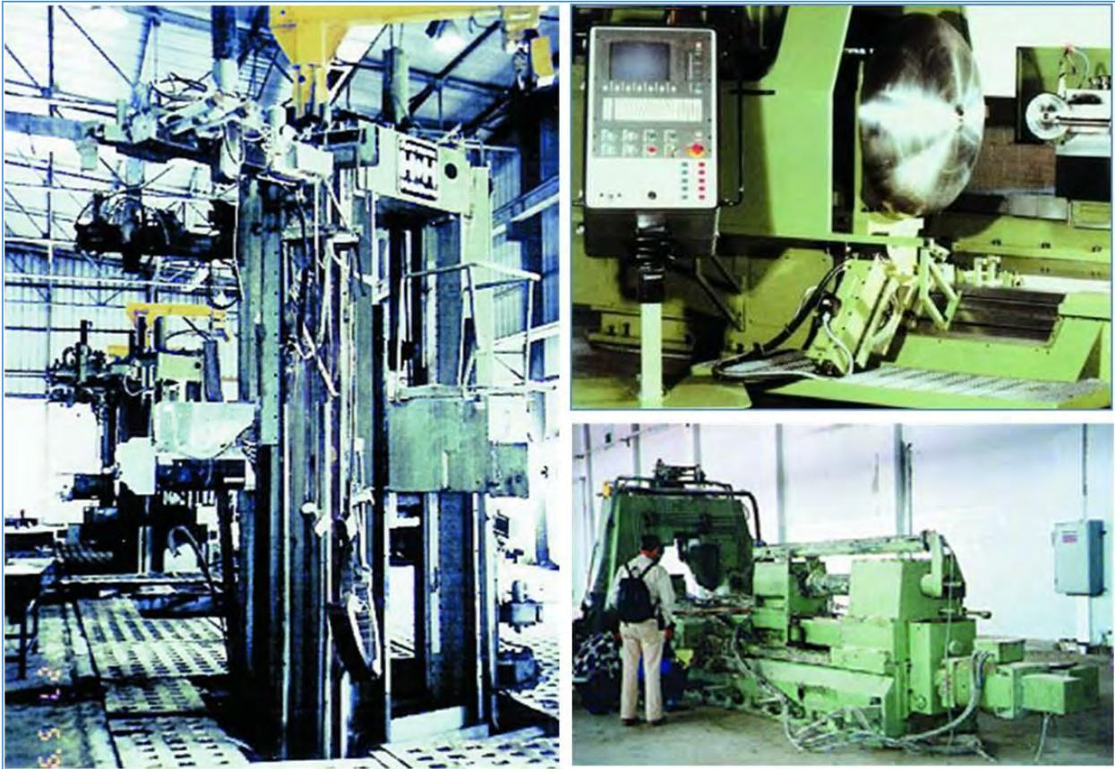
Schéma 47: *En haut à droite*: Machine de fluotournage utilisée pour fabriquer des dômes d'extrémité pour des réservoirs à propergol. (Aerojet) *en bas à droite*: Machine de fluotournage horizontale. (Un manuel pour le groupe de fournisseur nucléaire à double utilisation, rapport numéro LA-13131-M (avril 1996) gauche: Une machine fluotournage verticale (Ibid)
