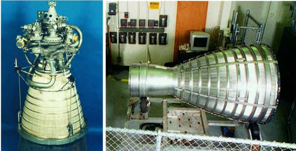
Schéma 45: *En haut à gauche*: Moteur fusée à propergol liquide muni d'une grosse tuyère refroidie par régénération. (Équipement de MTCR, logiciel et manuel de technologie, troisième édition (mai 2005) en bas à droite: Vue latérale d'une tuyère de fusée à propergol liquide à refroidissement par régénération, reliée à sa combustion.
