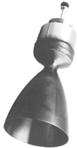
Schéma 46: Un petit propulseur de fusée qui utilise de l'hydrazine liquide monopropulseur. La paroi de la chambre de poussée est en métal mince, sans passage de refroidissement, ce qui fait que les surfaces sont de couleur foncée en raison des températures élevées. La partie métallique brillante reste plus froide grâce à l'écoulement du liquide à travers l'injecteur. La longueur totale est d'environ 0,1 m. (Aerojet Redmond and Lawrence Livermore National Laboratory)
