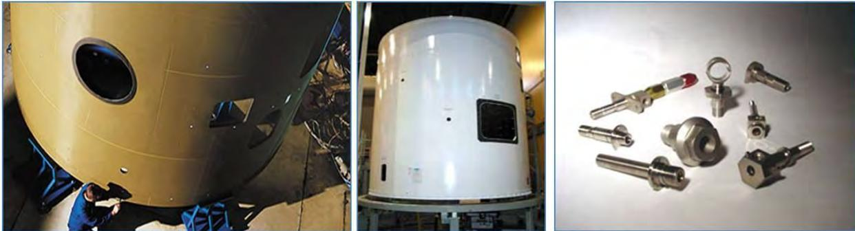
Schéma 37: Gauche: Une grande section à anneau central en composite conçue pour un lanceur spatial. (ATK) Centre: Une section interétage de fusée typique. (ATK) Droite: Une sélection de boulons explosifs conçue pour une utilisation dans des lanceurs spatiaux et des applications militaires.
