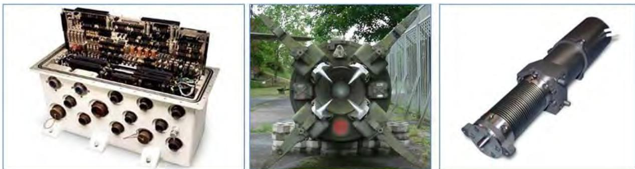
**Schéma 23:** *Gauche:* Une boîte de circuits de commande de vecteur de poussée pour usage dans des applications lanceurs de grande taille. (Moog, Inc.) *Centre:* Quatre aubes directrices de jet montées à l'arrière d'un missile balistique. (Armée russe) *Droite:* Un mécanisme linéaire de positionnement fin conçu pour usage dans des applications spatiales. (Moog, Inc)
