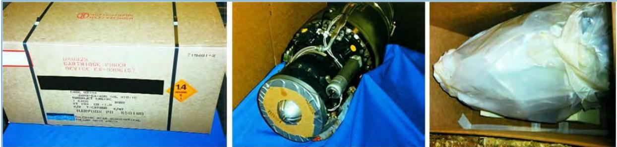
**Schéma 29:** *Gauche:* Une caisse d'expédition de turboréacteur avec les étiquettes d'avertissement aux explosifs requises en raison de la cartouche de mise en route. (Teledyne Ryan Aeronautical) *Centre:* Un petit moteur de turbopropulseur enveloppé de plastique à l'intérieur de sa caisse d'expédition. (Teledyne Ryan Aeronautical) *Droite:* Un petit moteur de turboréacteur étant préparé pour l'expédition (Teledyne Ryan Aeronautical)
