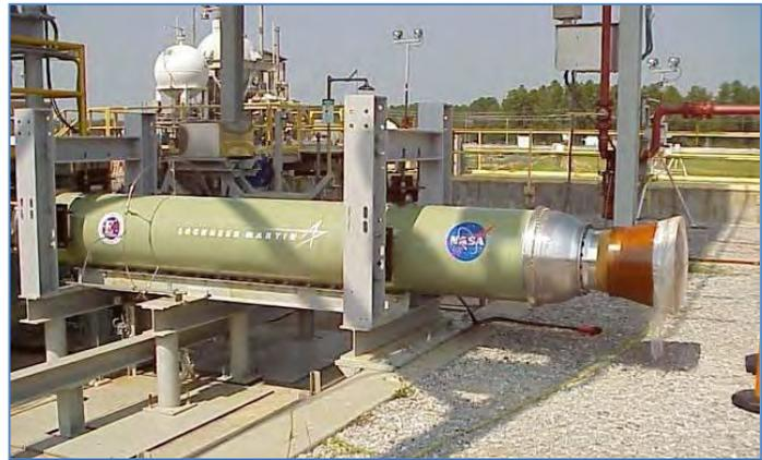
Schéma 41: Un moteur fusée à sonde hybride (NASA)
