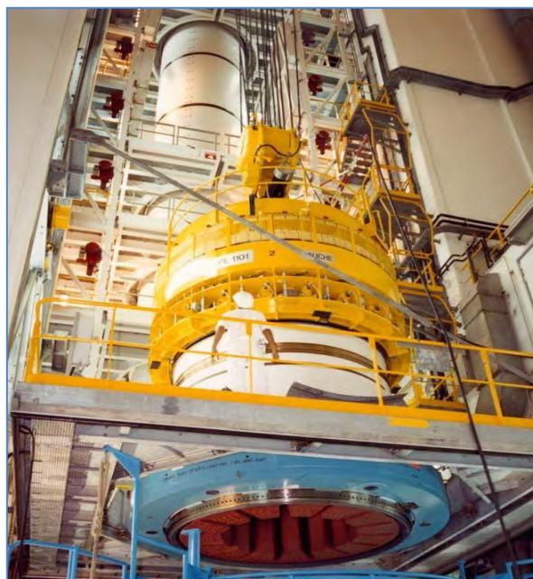
Schéma 12: Étage de moteur fusée à propergol solide positionné sur un lanceur spatial (ci-dessus). (Agence spatiale européenne)
