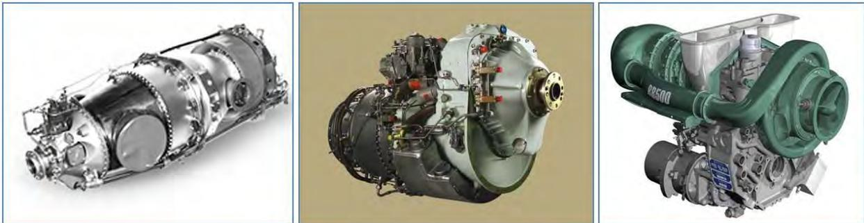
Schéma 44: *Gauche:* Un moteur de turbopropulseur utilisé pour actionner des véhicules aériens sans pilote contrôlés sous 19. A.2 du MTCR. (Pratt & Whitney Canada) *Centre:* Un moteur de turbopropulseur utilisé pour actionner un véhicule aérien sans pilote contrôlé par 1.A.2 du MTCR. (Honeywell) *Droite:* Un moteur de turbomoteur a conçu pour l'usage dans diverses applications de véhicules aériens sans pilote. (Rolls Royce, plc)
