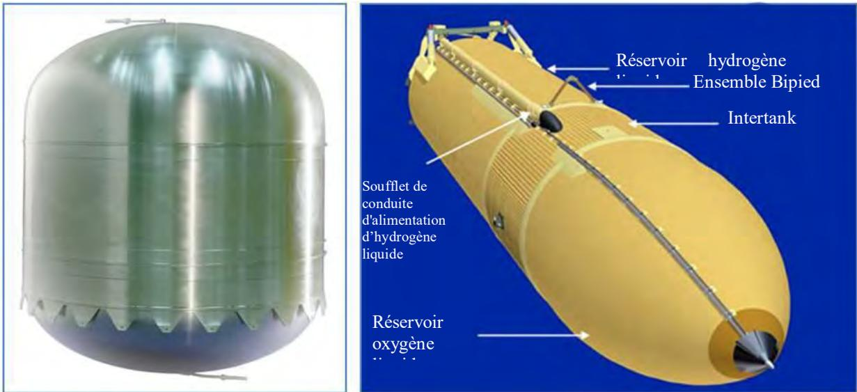
**Schéma 43 à Gauche:** Un réservoir de propergol liquide typique développé pour une portée d'applications spatiales. (EADS) **Droite:** Un diagramme du réservoir externe employé par un moteur de lanceur de véhicule spatial, montrant les réservoirs de comburant et de carburant séparés. (NASA)
