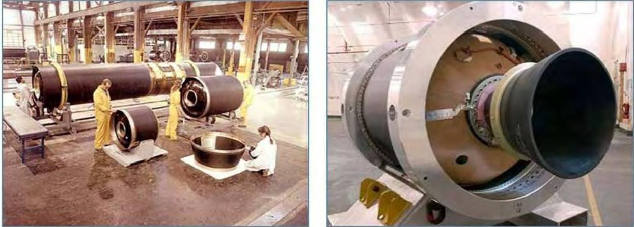
Schéma 33: *Gauche:* Une sélection d'enveloppes composites de moteur-fusée a été conçue pour soutenir une portée de plates-formes de mission, notamment les étages de fusée du premier, deuxième et troisième étage de lanceurs spatiaux. (ATK) (ATK) *Droite:* Un moteur-fusée (installé dans une enveloppe de fusée) qui fonctionne comme moteur dans le troisième étage d'un lanceur. (ATK)
