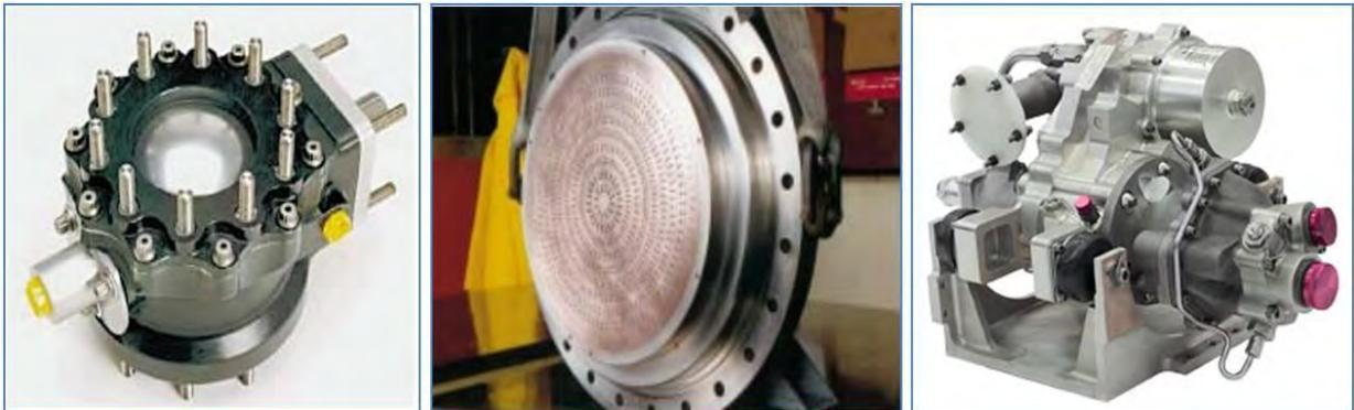
**Schéma 39:** *Gauche:* Une vanne de commande à propergol liquide moderne (Allied Signal Aerospace) *Centre:* Une plaque d'injecteur de propergol liquide. (Boeing) *Droite:* Un ensemble de turbopompe pour un lanceur spatial. (Hamilton Sundstrand)
