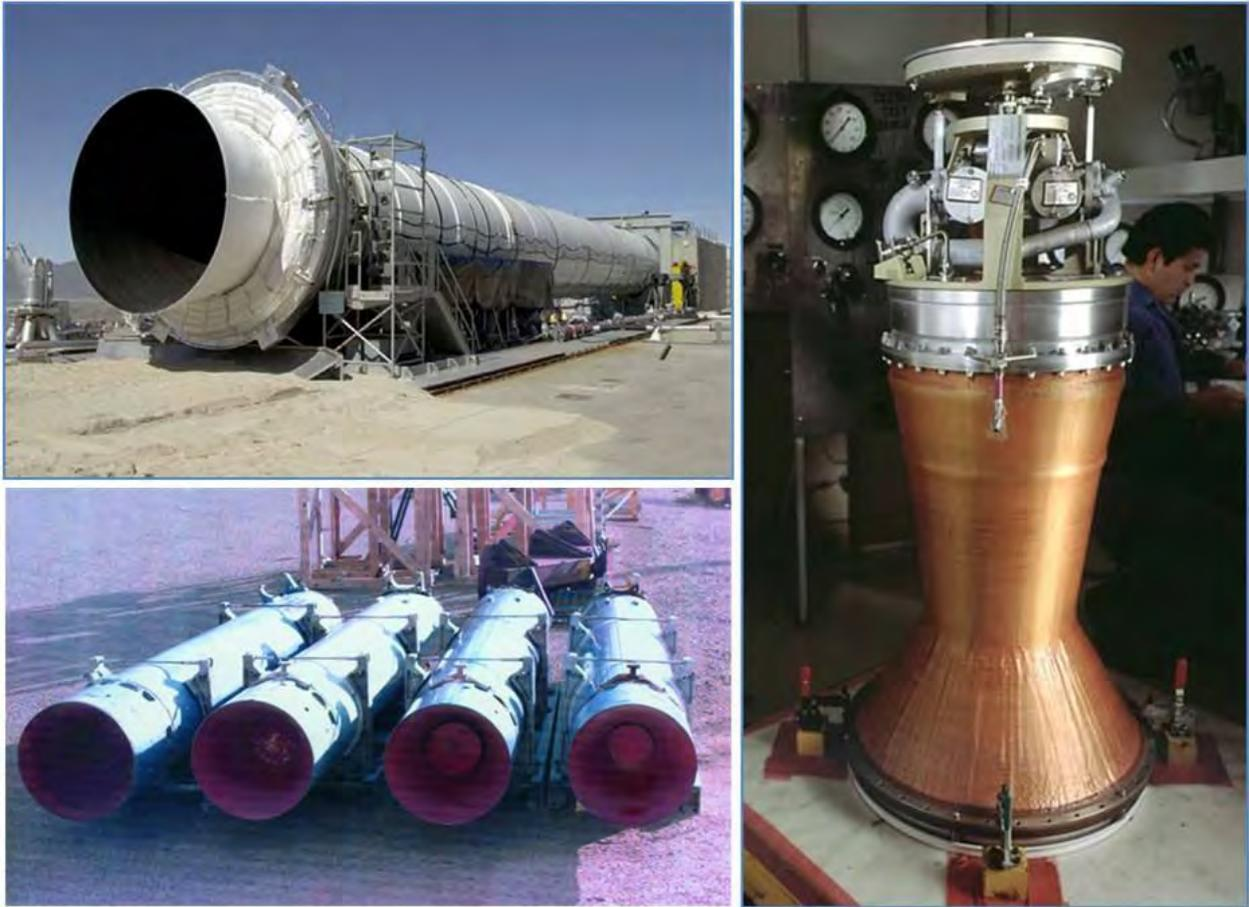
Schéma 18: *En haut à gauche*: Un moteur-fusée à propergol solide réutilisable pour l'usage de véhicule spatial (ATK) *en bas à gauche*: Moteur-fusée à propergol solide à impulsion totale proche de la limite inférieure de la commande de l'article 2. (Équipement de MTCR, logiciel et manuel de technologie, troisième édition (mai 2005) Droite: Un moteur-fusée à propergol liquide alimenté sous pression. (Aerojet)
