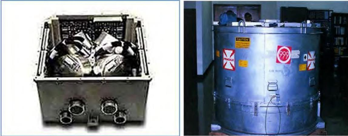
Schéma 22: *Gauche*: Un système de guidage et de navigation, conçu pour répondre aux exigences de mission spatiale de longue durée. (Northrop Grumman) *Droite*: Un conteneur d'expédition pour un système de guidage ICBM.
