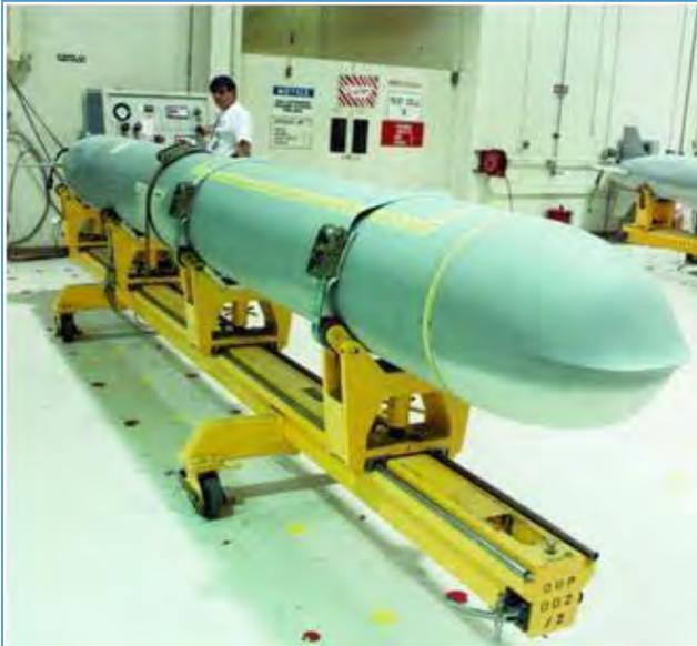
**Schéma 7: Un missile de croisière opérationnel sur sa caisse de sortie, montrant son cône de nez modifié pour réduire les échos radar et améliorer les performances aérodynamiques. (Équipement de MTCR, logiciel et manuel de technologie, troisième édition (Mai 2005))**
