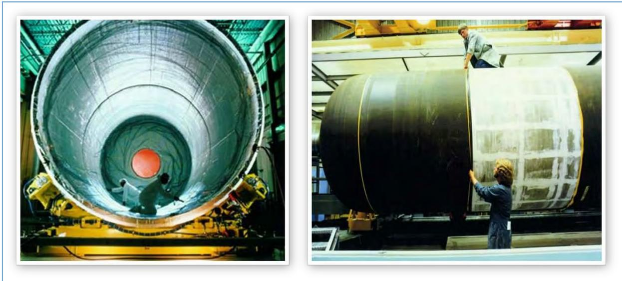
Schéma 36: *gauche*: Installation d'isolation à l'intérieur d'une enveloppe de moteur fusée. (Thiokol Corp.) *Droite*: Une enveloppe de moteur fusée sous inspection après application de l'isolation thermique. (Fiat Avio)
