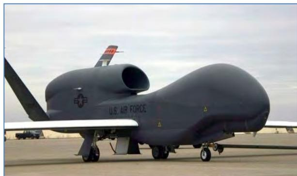
Schéma 5: Un véhicule aérien sans pilote (UAV) à grande autonomie en haute altitude (HALE). (l'Armée de l'air des États-Unis)
