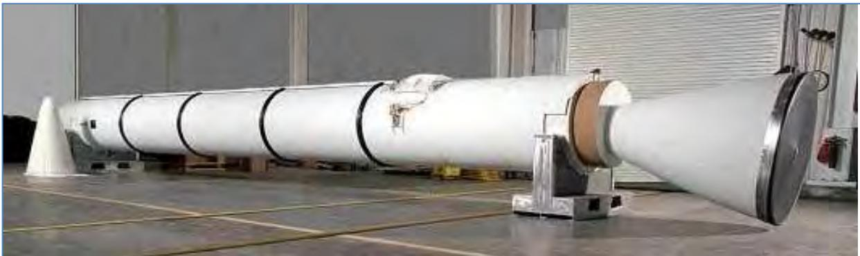
Schéma 35: Un moteur fusée avec une grande tuyère fixe. Le moteur est utilisé sur un lanceur. (ATK)
