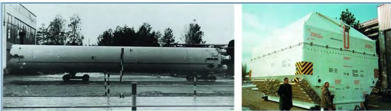
附图13 左侧：液体燃料洲际弹道导弹的第一级。右侧：用于液体燃料上面级的运输容器。（《MTCR设备、软件和技术手册》第三版，（2005年5月））
