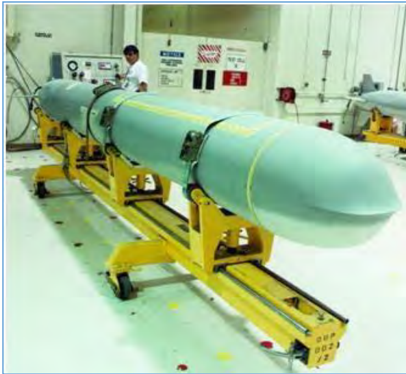
附图7：在检验台上可操作的巡航导弹，显示其经过改良的鼻锥，以降低雷达回波并增强空气动力学性能。（《MTCR设备、软件和技术手册》第三版，（2005年5月））
