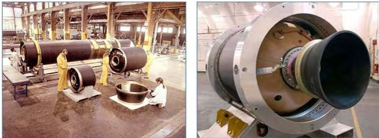
附图33：左侧：一系列复合火箭发动机壳体，主要设计用于支持一系列任务平台，包括航天运载火箭的第一级、第二级和第三级火箭。（ATK） 右侧：一种火箭发动机，装在外壳内，作为运载火箭的第三级。（ATK）
