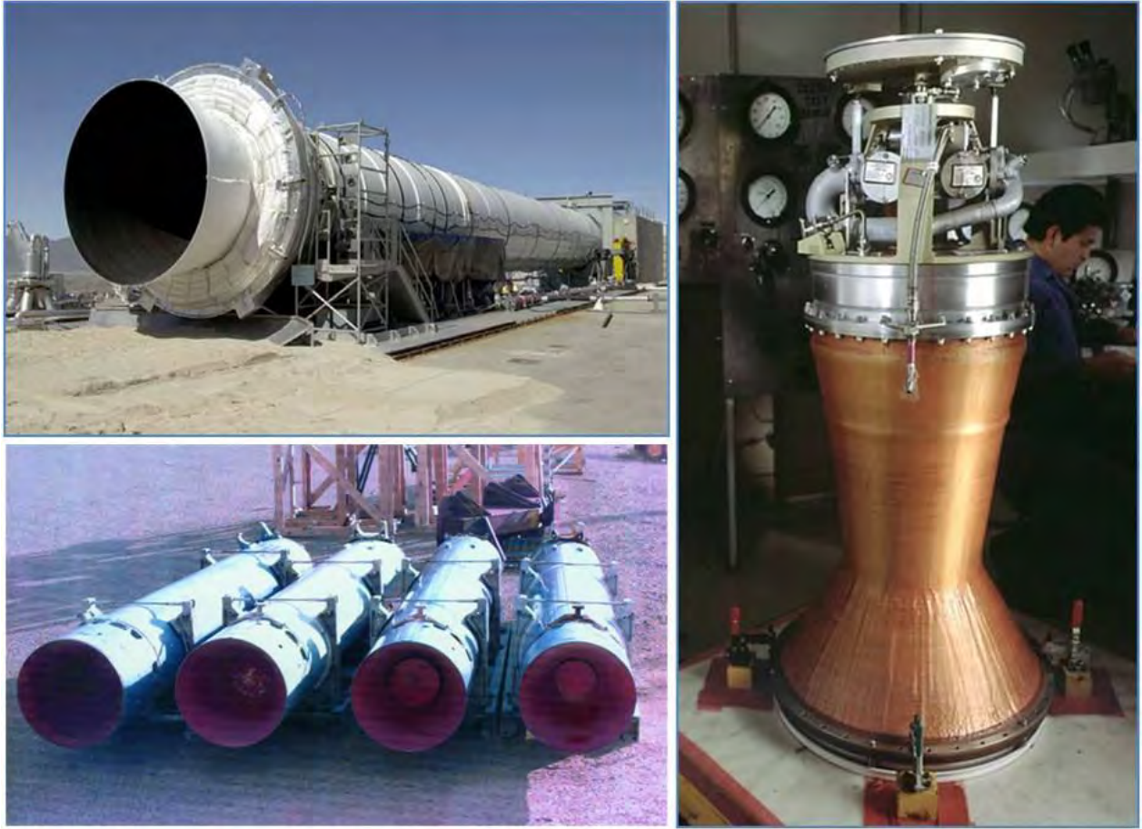
附图18：左上角：一种可重复使用的太空飞行器固体火箭发动机。（ATK）左下角：总冲量接近项目2控制下限的固体推进剂火箭发动机。（《MTCR设备、软件和技术手册》第三版，（2005年5月））右侧：挤压式液体火箭发动机。（Aerojet）
