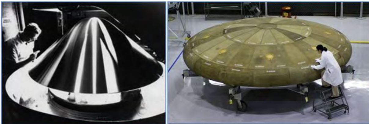
附图16：左侧：铍铜散热器。（国家原子博物馆）右侧：从月球和近地轨道任务返回的飞行器上所用的隔热罩原型。（波音公司）
