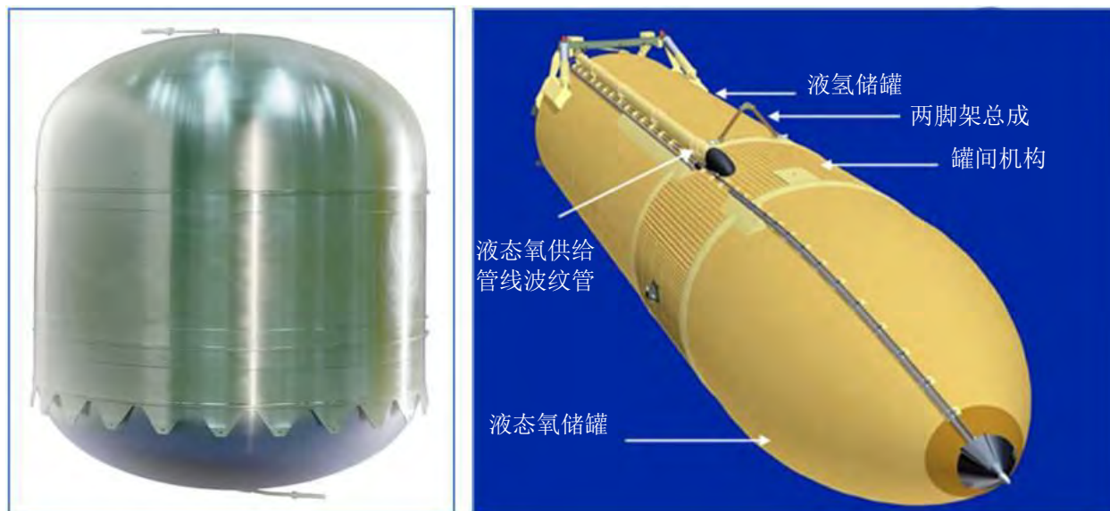
附图43 左侧：一种典型的液体推进剂罐，专门开发用于一系列航天应用。（EADS） 右侧：航天运载火箭发动机使用的外部燃料罐示意图；所示为独立的氧化剂罐和燃料罐。（NASA）
