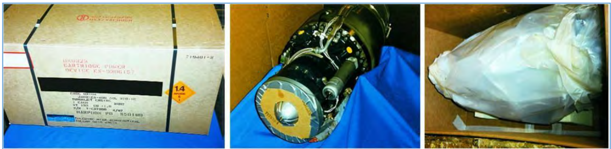
附图29：左侧：一种涡轮喷气发动机装运箱，显示由于存在启动烟火弹而需要的爆炸物警告标签。（Teledyne Ryan Aeronautical）中间：一种小型涡扇发动机，采用塑料包裹并放在装运箱里。（Teledyne Ryan Aeronautical）右侧：正在准备装运的小型涡轮喷气发动机。（Teledyne Ryan Aeronautical）
