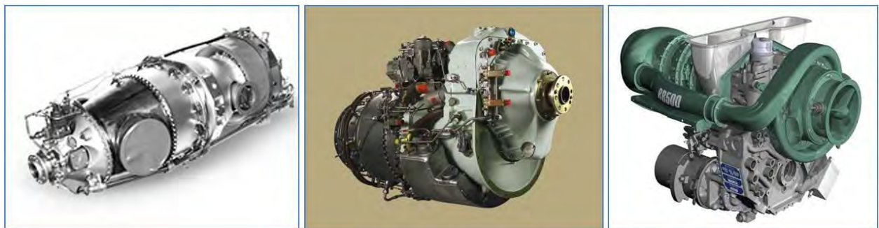
附图44：左侧：一种涡轮螺旋桨发动机，用于驱动MTCR项目19.A.2项下受管制的无人机。（Pratt & Whitney Canada）中间：一种涡轮螺旋桨发动机，用于驱动MTCR项目1.A.2项下受管制的无人机。（Honeywell）右侧：一种涡轴发动机，设计用于一系列无人机应用。（Rolls Royce, plc）
