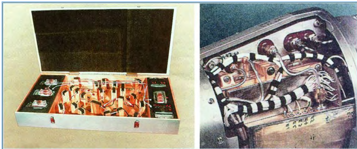
附图17：左侧：一套包装好准备运输的再入飞行器天线。右侧：再入飞行器雷达电子部件的一部分。 （《MTCR设备、软件和技术手册》第三版，（2005年5月））
