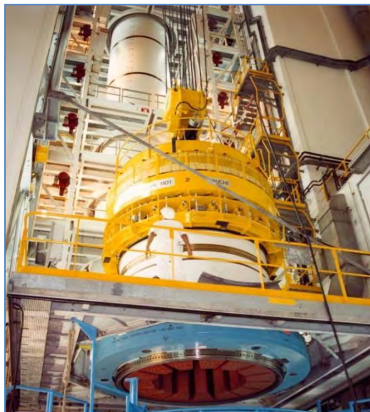
附图12：固体推进剂火箭发动机级正在安装到航天运载火箭（上图）（欧洲太空总署）
