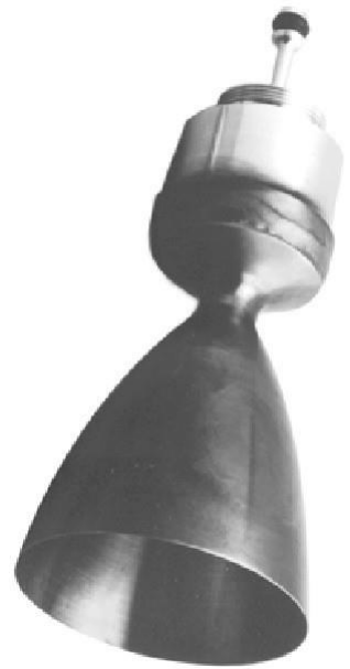
附图46：一种使用液体肼单一推进剂的小型火箭推进器。推力室壁为薄金属制成，无冷却通道，表面颜色因高温变得暗淡。由于液体流经注射器，光亮金属部分会保持较低的温度。整体长度约0.1米（Aerojet Redmond and Lawrence Livermore National Laboratory）
