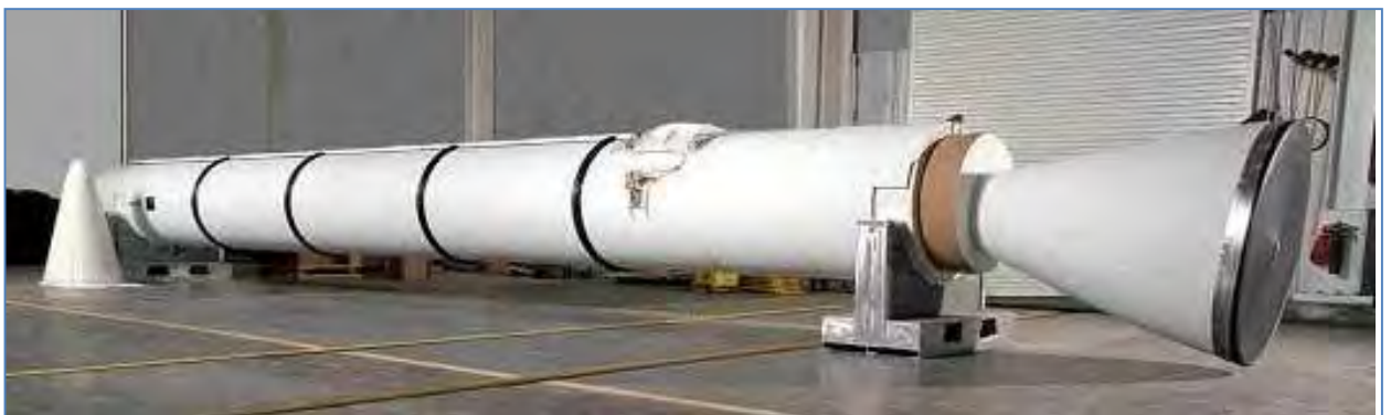
附图35：一种火箭发动机，设有一个固定的大型倾斜喷嘴。该发动机用于运载火箭。（ATK）
