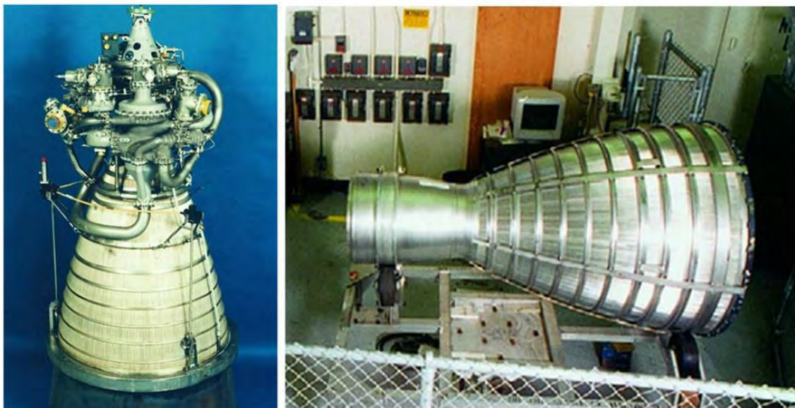
附图45：左上角：一种液体火箭发动机，配备一个再生冷却大喷嘴。（《MTCR设备、软件和技术手册》第三版，（2005年5月））右下角：再生冷却液体火箭喷嘴的侧面图，连接到其燃烧室
