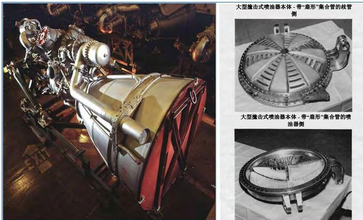
附图20：左侧：一种二级氧/煤油液体推进剂火箭发动机。（Aerojet）右侧：注射器头部的圆形壳体封头（上图）及其底部，显示注射器和挡板（《MTCR设备、软件和技术手册》，第三版（2005年5月））
