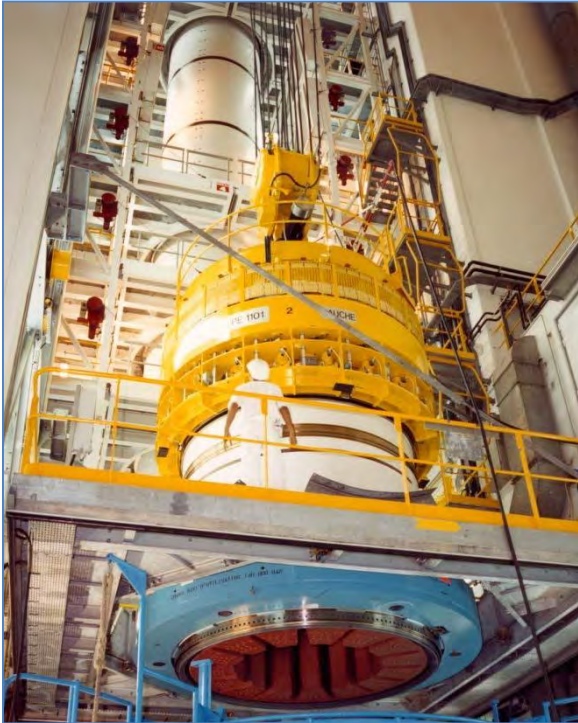
الشركل 12: مكونات مركبة المصنوع الصاروخي القابل للقود اللععي الصلبي بتتوضع على متن مركبة إطلاق فضيية (أعله) ولتلقا فضاء الأروبيية).
