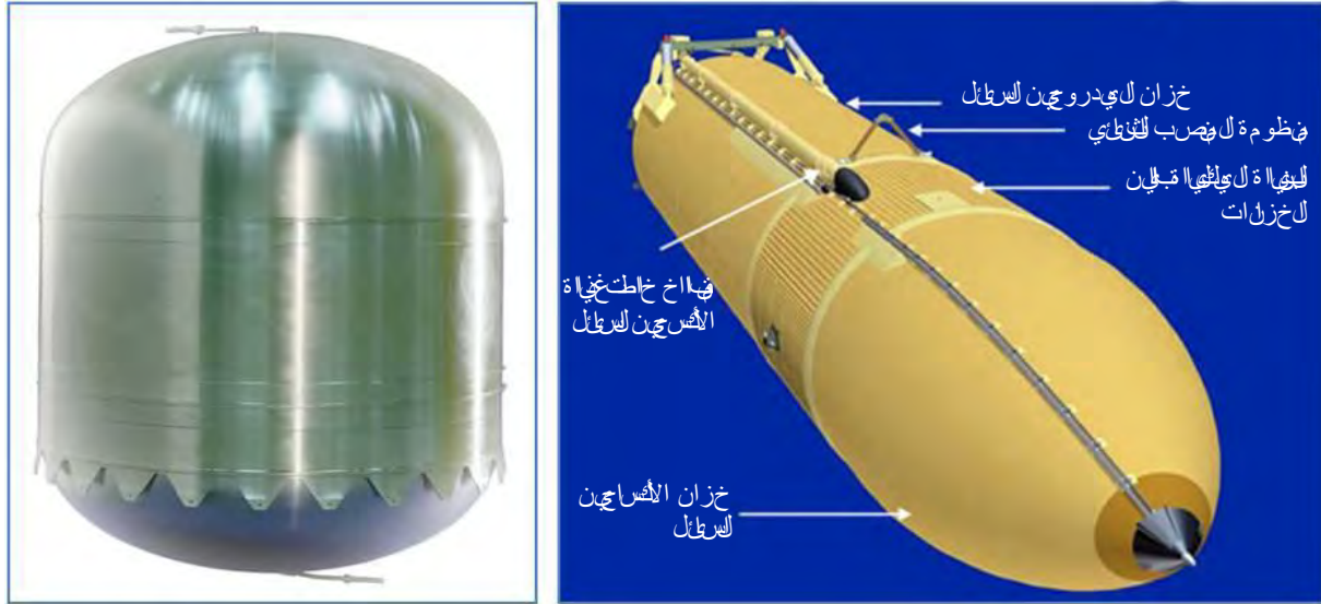
الشكل 43: قوودفدعي خزان قوودفدعي سطلين نموذجي مطور لمجموعة من الاستخداماتسي مجال الفضاء. (اي ليه دي إس) قوودفدعي اليبسار: سببيل بيظمر اللخزان اللارجي لمستخدعي مخصص للمرفبة إطلاقفضبطية، يبين خزلات المادةالموكسدة والقوودالفضولة عنبعضه. (بلس)
