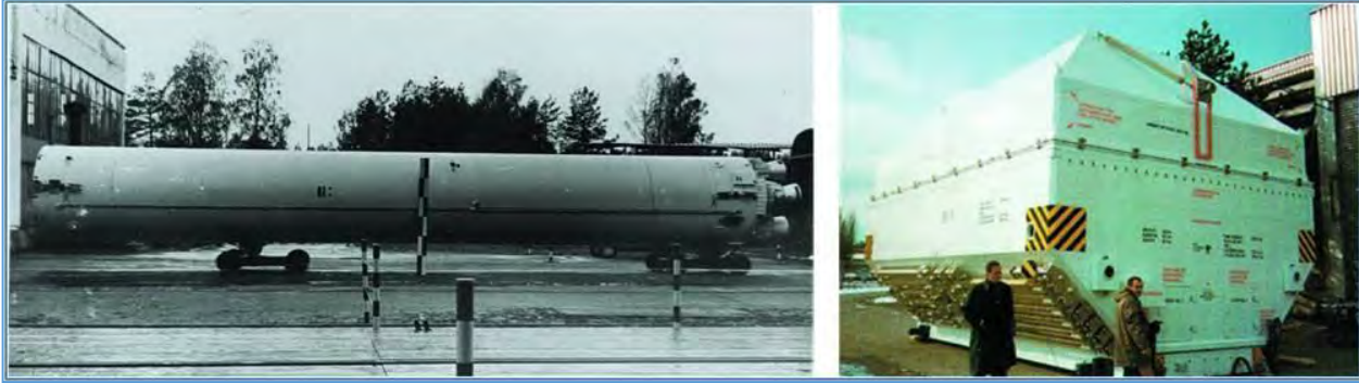
الشكل 13 على اليسار: لمرحلة الأولى من صاروخ عبر للقاراتي عمل بالوقود للصلب. على اليمين: حاوية شحن مخصص للمرحلة العلوية التي تتعمل بالوقود للصلب. (دليل معدات وبرمجيات وتكنولوجيا نظام مراقبة تكنولوجيا القذائف، الإصدار الثالث) يوليو 2002
