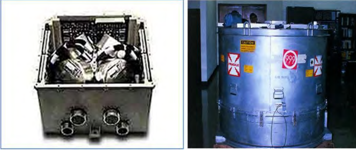
الشكل 22: شى الپسار: نظام التوجيه ول ملاحه، من ملل فاب تطليات ال م هام الفضي طوله الأجل. (نوثر ووب غرومان). على لپسار: حاوي عشحن لنظام توجي مصاروخ علبل لقرارات.
