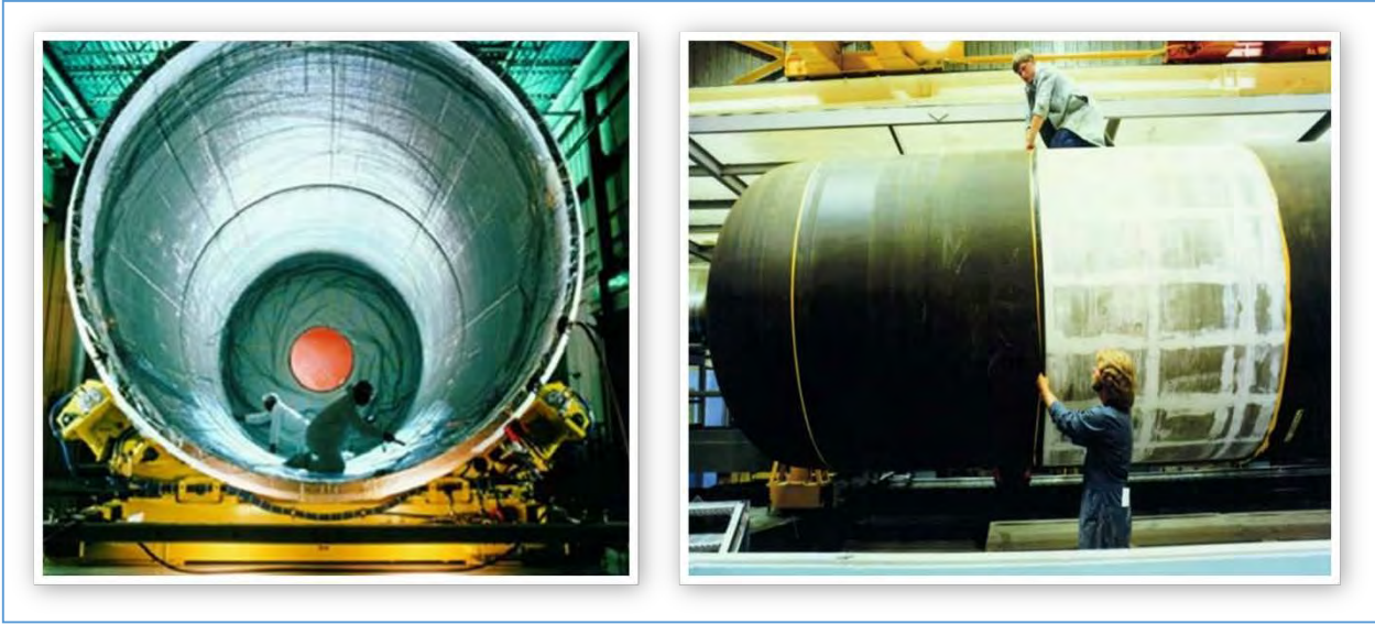
الشكل 36: على لييسار بتريجب مادة العزل داخل غطاء محوصاروخي مقصوفسفلون. بيجوكولكوروب (على لييسار: غلاف محوصاروخي في دال معين قبع د تطويق العزل الحراري. هي اتقليو)
