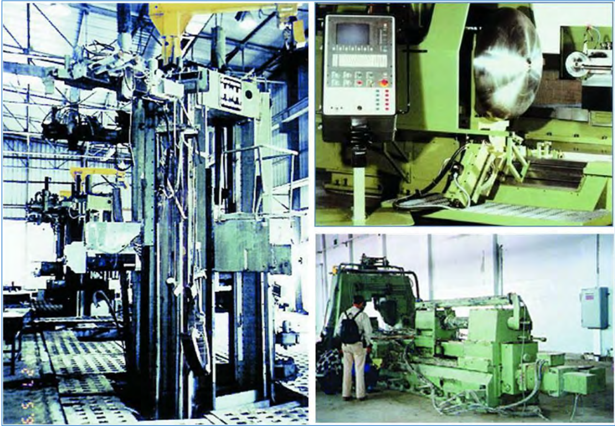
Imagen 47: Parte superior derecha: Una máquina de formación de flujo utilizada para hacer domos finales para tanques de propulsante. (Aerojet) Abajo a la derecha: Una máquina formadora de flujo horizontal. (Manual para el anexo de doble uso del Grupo de Proveedores Nucleares, Informe n.º LA-13131-M (abril de 1996) Izquierda: Una máquina de formación de flujo vertical. (Ibídem)
