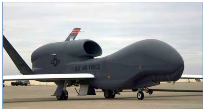
Imagen 5: Un vehículo aéreo no tripulado (UAV) de alta resistencia y larga resistencia (HALE). (Fuerza aérea de los EE. UU.)
