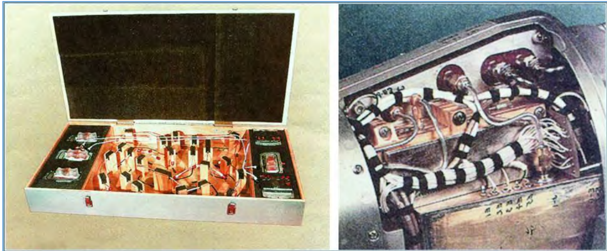
Imagen 17: Izquierda: Un conjunto de antenas de radar de RV embalado para su envío. Derecha: Una parte de la electrónica del radar RV. (Manual de equipo, programas informáticos y tecnología del MTCR, tercera edición (mayo de 2005))
