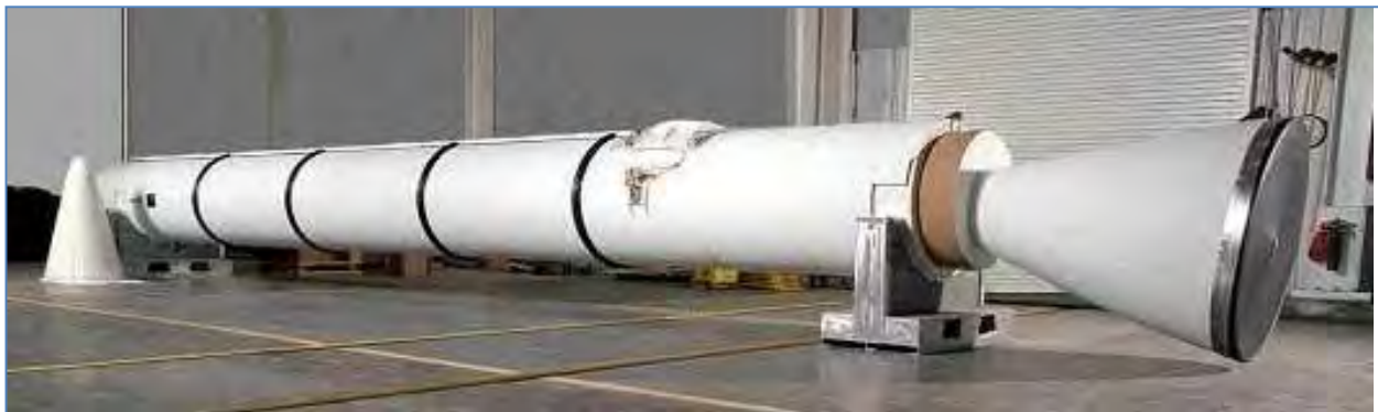
Imagen 35: Un motor cohete con una gran tobera inclinada fija. El motor se usa en un vehículo de lanzamiento. (ATK)
