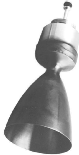
Imagen 46: Un pequeño propulsante de cohetes que utiliza monopropelente de hidrazina líquida. La pared de la cámara de empuje es de metal delgado sin pasajes de enfriamiento, por lo que las superficies se oscurecen debido a las altas temperaturas. La porción de metal brillante permanece más fría debido al flujo de líquido a través del inyector. La longitud total es de aproximadamente 0,1 m. (Laboratorio Nacional Aerojet Redmond y Lawrence Livermore)
