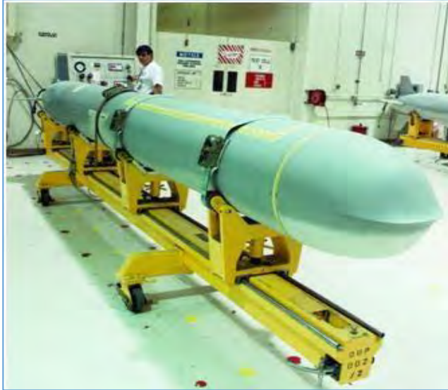
Imagen 7: Un misil de crucero operativo en su puesto de salida, que muestra su cono de ojiva modificado para reducir los retornos del radar y mejorar el rendimiento aerodinámico. (Manual de equipo, programas informáticos y tecnología del MTCR, tercera edición (mayo de 2005))
