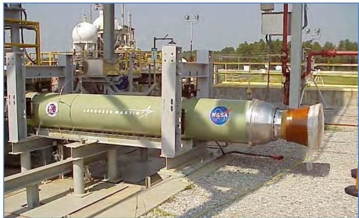
Imagen 41: Un motor de cohete híbrido. (NASA)
