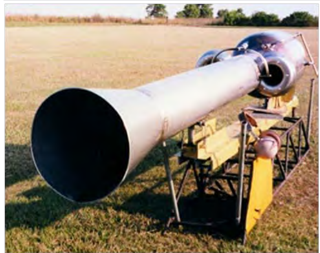
Imagen 30: Parte superior: Un gran motor de estatorreactor. (March Field Air Museum) Medio: Un motor de estatorreactor de combustión supersónica completa una prueba Mach 5 en una instalación de túnel de viento. (Pratt & Whitney/NASA) Parte inferior: Un moderno motor de pulsorreactor con una admisión orientada hacia atrás. (Thermojet)
