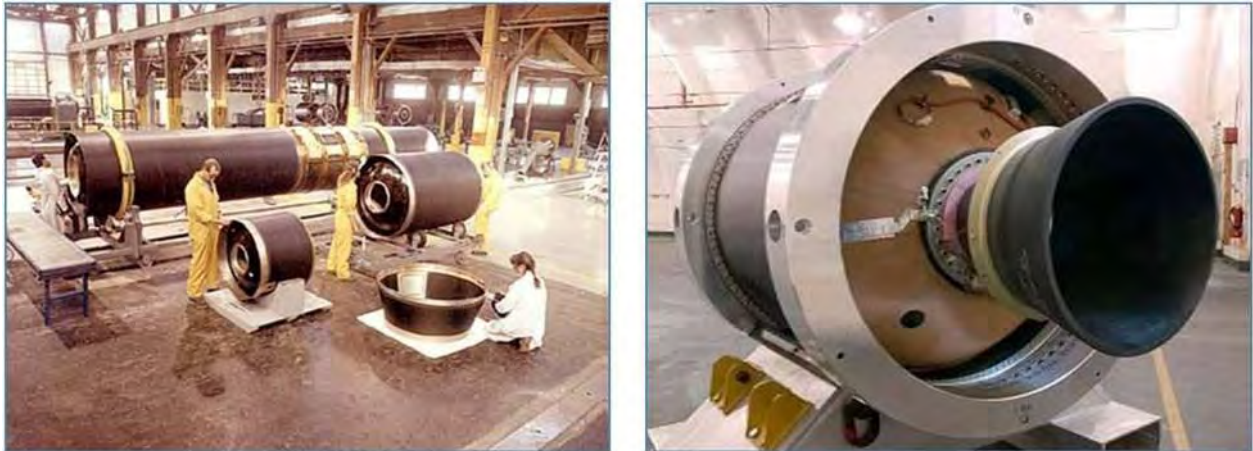
Imagen 33: Izquierda: Una selección de carcasas de motores de cohetes compuestos diseñados para soportar una gama de plataformas de misiones, incluidas las etapas de cohetes de primera, segunda y tercera etapa de un vehículo de lanzamiento espacial. (ATK) Derecha: Un motor de cohete, instalado en una carcasa, que funciona como la tercera etapa de un vehículo de lanzamiento. (ATK)
