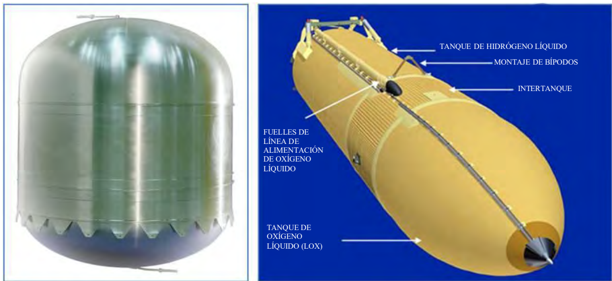
Imagen 43 Izquierda: Un tanque de propulsante líquido típico desarrollado para una gama de aplicaciones espaciales. (EADS) Derecha: Un diagrama del tanque externo utilizado por un motor de lanzamiento de un vehículo espacial, que muestra el oxidante separado y los tanques de combustible. (NASA)
