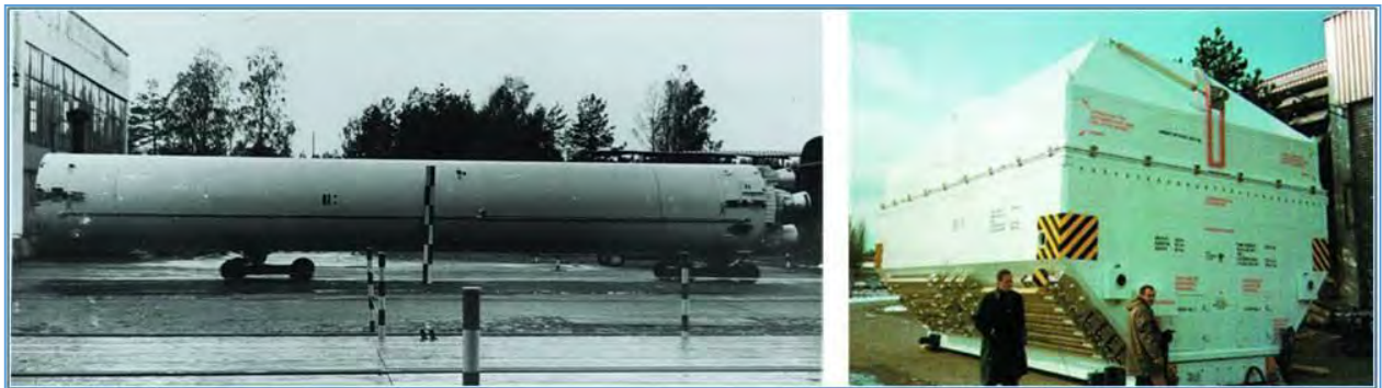
Imagen 13 Izquierda: La primera etapa de un ICBM de combustible líquido. Derecha: Un contenedor de envío para una etapa superior de combustible líquido. (Manual de equipo, programas informáticos y tecnología del MTCR, tercera edición (mayo de 2005))
