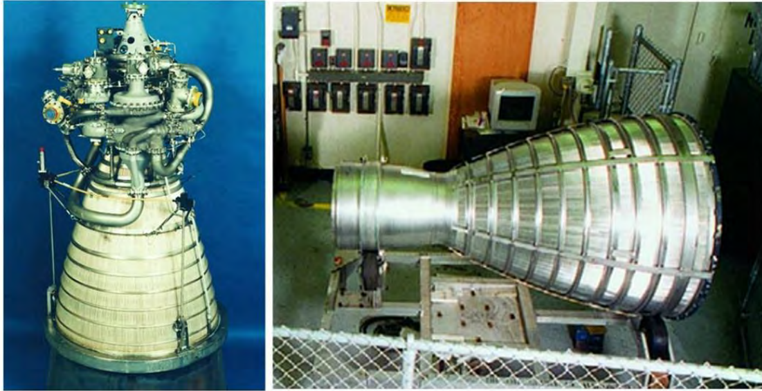
Imagen 45: Arriba a la izquierda: Un motor de cohete de propulsante líquido con una tobera grande, refrigerada por regeneración. (Manual de equipo, programas informáticos y tecnología del MTCR, tercera edición (mayo de 2005)) Abajo a la derecha: Vista lateral de una tobera de cohete líquida enfriada regenerativamente, unida a su combustión
