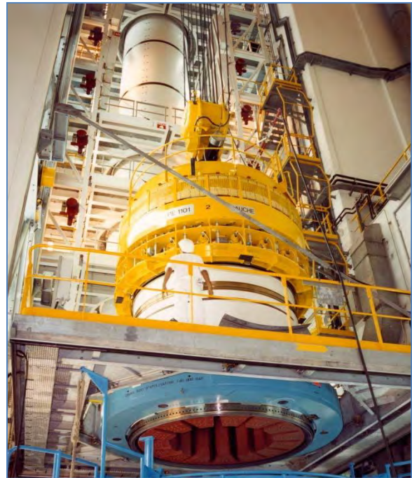
Imagen 12: Etapa sólida del motor del cohete propulsante que se coloca en un vehículo de lanzamiento espacial (arriba). (Agencia Espacial Europea)
