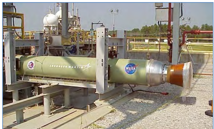
Imagen 19: Un motor de cohete híbrido. (NASA)
