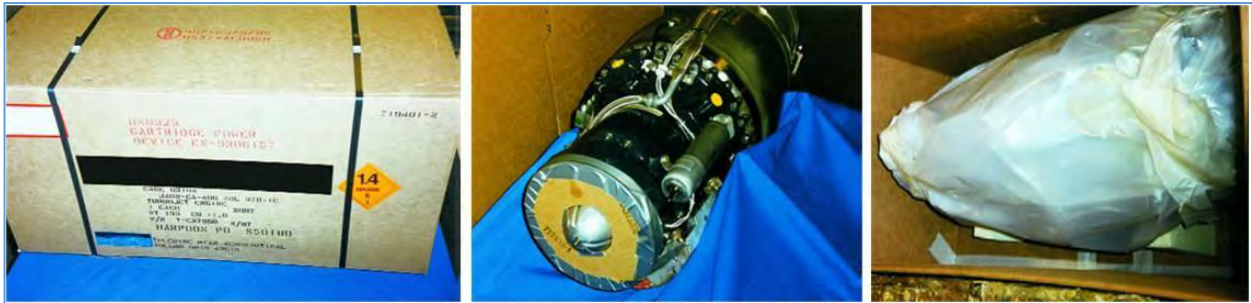
Imagen 29: Izquierda: Un cajón de envío de un turbo reactor que muestra las etiquetas de advertencia de explosivos necesarias debido al cartucho de arranque. (Teledyne Ryan Aeronautical) Centro: Un pequeño motor de turboventilador envuelto en plástico dentro de su cajón de envío. (Teledyne Ryan Aeronautical) Derecha: Un pequeño motor turbo reactor en preparación para su envío. (Teledyne Ryan Aeronáutica)
