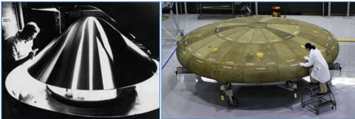
Imagen 16: Izquierda: Un dissipador de calor de berilio y cobre. (Museo Nacional Atómico) Derecha: Un prototipo de escudo térmico para usar en vehículos durante el reingreso desde misiones lunares y de órbita terrestre baja. (Boeing)
